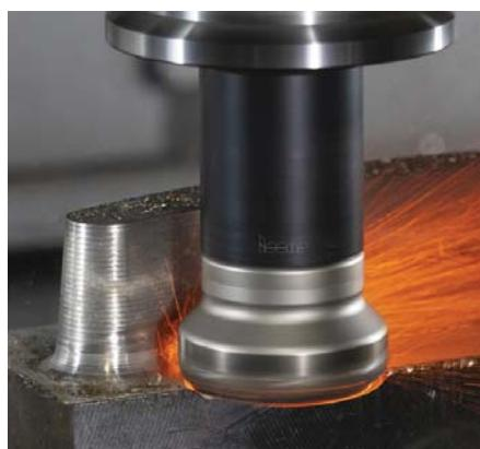
Obr. 3 Frézy s vymeniteľnými kruhovými doštičkami z keramiky poskytujú výrazne vyššie rezné rýchlosťi pre vyššiu produktivitu.
