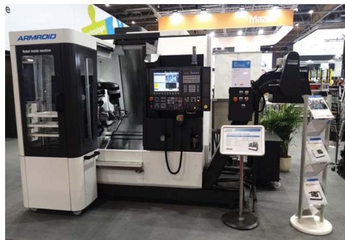
matizácie reaguje na požiadavku automatizovanej kusovej a malosériovej výroby dielcov s vysokou pridanou hodnotou. Inovatívne riešenie kompletnie integruje riadenie robotického ramena do NC systému stroja a prináša novú úroveň zaistenia kvality a stability výroby.
