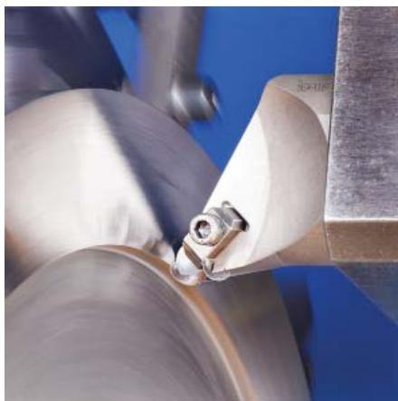
Obr. 1 Superzliatiny sú klúčovými materiálmi pre prúdové a vrtuľové motory moderných lietadiel. Turbína obrábaná systémom CUT-GRIP od ISCARu.
