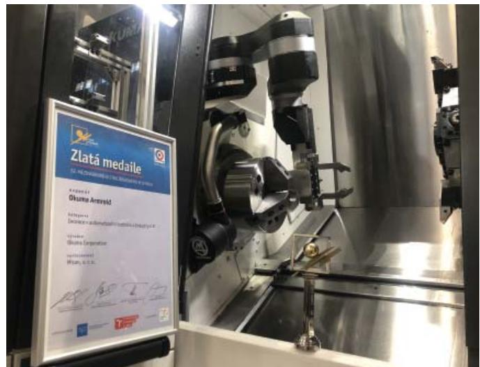
ky generuje pohyby robota tak, aby nedocházelo ke kolizím se stroji nebo s obrobkem. Před obráběním je možné ve 3D simulovat pohyby robota a vyloučit případné vzájemné kolize se strojem a obrobkem. Operátorovi umožňuje systém, v případě potřeby, ovládat robota ručně téměř s chirurgickou přesností. Bez omezení vlastního pracovního prostoru stroje je ve stroji zabudován také 3 polohový zásobník nástavců chapadla, které lze využít pro různé typy obrobků nebo pro další technologické funkce.
