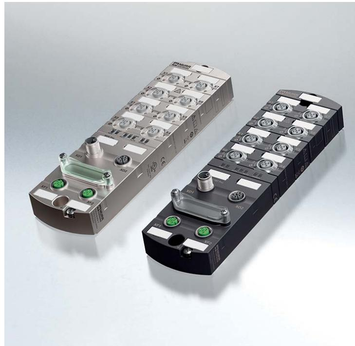
Zbernicové moduly IP67 „MVK Pro“ a „Impact67 Pro“ sú kompletne novými vývojovými produktmi a rozširujú IO-Linkové portfólio spoločnosti Murrelektronik. Okrem iného ponúkajú všetky bežné protokoly alebo používanie nezávislé od zbernice, výstupný prúd portu 4A, diagnostiku On Board a robustné teleso.
