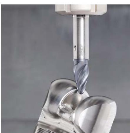
Obr. 2 Obrábanie implantátu femorálneho klíbu pomocou vymeniteľnej MULTI-MASTER kužeľovej frézy.
