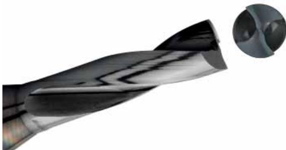
MFE vrtáky sa používajú pre zahľbovacie vrtanie a pre ploché dna otvorov. Majú jedinečne ostré hrany – ploché rohové fazetky poskytujú väčšiu pevnosť a ostrosť, čím podstatne znižujú vytrhávanie hrán (otrepov). MFE vrtáky nepotrebujú pilotný vrták ako konvenčné zahľbovacie vrtáky. Ich veľkou výhodou je možnosť nasadenia aj do šikmých a zakrivených plôch priamo, bez akejkoľvek prípravy.
