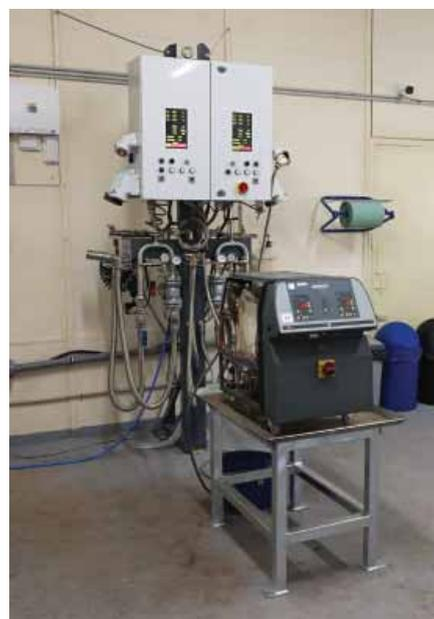
Obr. 5 Testovacia stanica na temperačné prístroje
