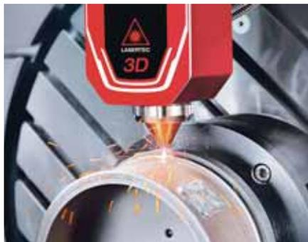
Zařízení LASERTEC 65 3D hybrid je kombinací aditivní výroby a konvenčního obrábění v rámci jediné sestavy.
