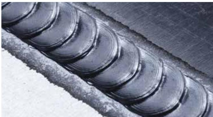
Preplátovaný zvar: 3 mm, hliník, prídavný drôt: AlSi5 1,2 mm; počet cyklov CMT: 18, čas prestávky: 0,16 s; rýchlosť zvárania: 50 cm/min, rýchlosť podávania drôtu vo fáze procesu CMT: 7,7 m/min, stredná rýchlosť podávania drôtu: 6,1 m/min. Upozornenie: Stredná hodnota je nižšia ako nastavená hodnota.
