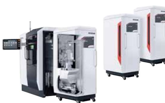
Flexibilní práškový modul rePLUG umožňuje provádět změnu materiálu za méně než dvě hodiny.
