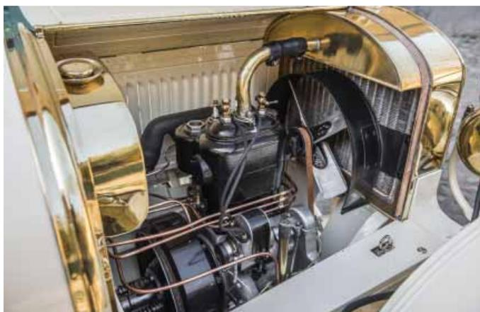
Všechny podstatné části vozu jsou původní, včetně motoru s výrobním číslem 5635. Řadový kapalinou chlazený dvouválec o objemu 1 399 cm<sup>3</sup> dosahoval na dobové palivo výkonu 12 k (8,8 kW).
