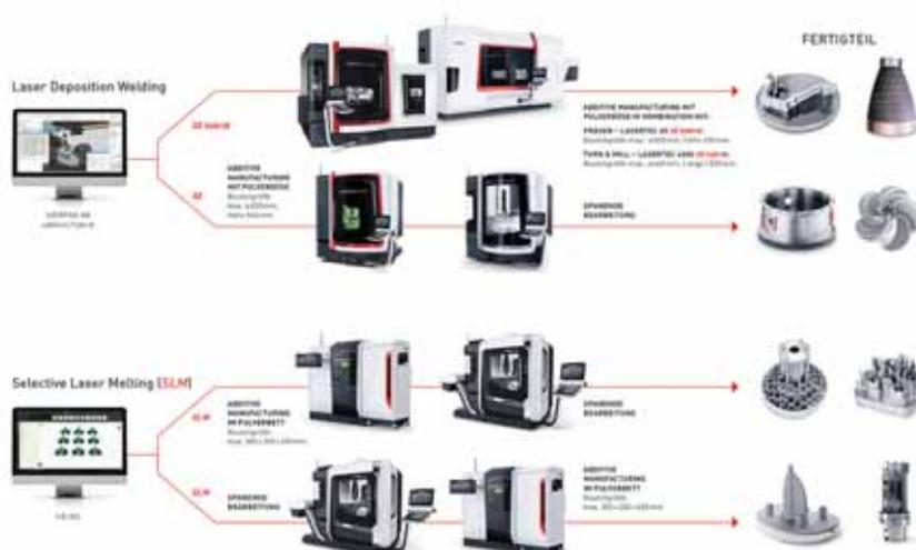
Portfolio DMG MORI v oblasti ADITIVNÍ VÝROBY zahrnuje čtyři úplné výrobní procesy využívající práškové trysky a práškové lože.
