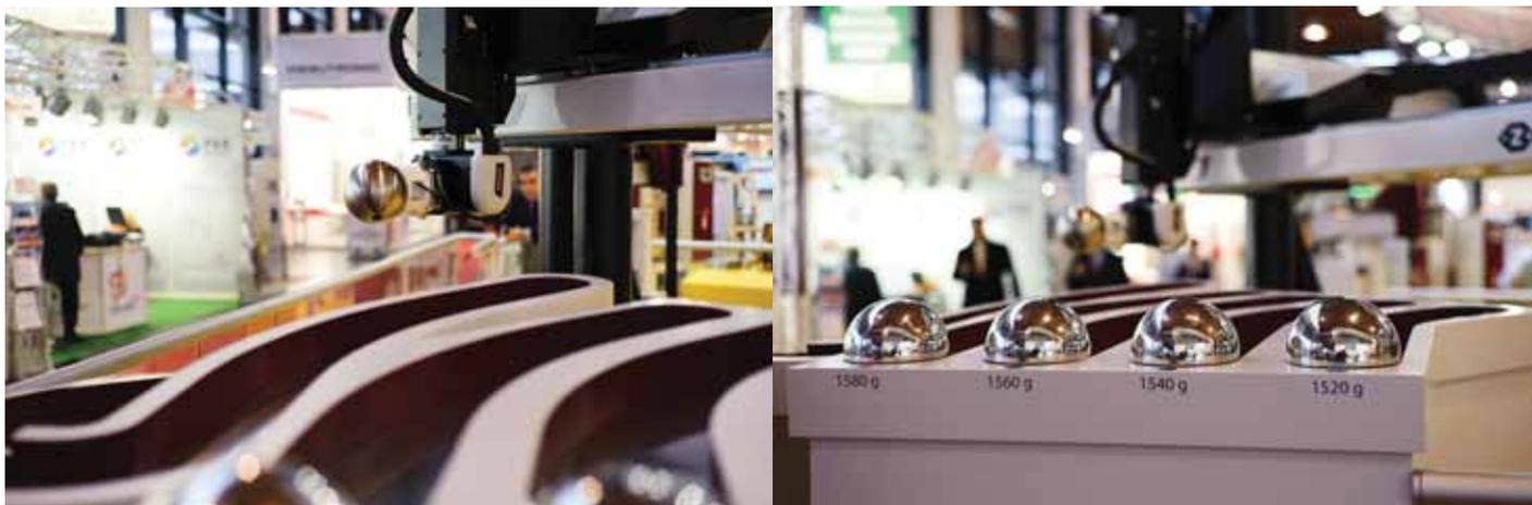
Obr. 9 Robot WITTMANN W833 Pro s váhou pre kontrolu hmotnosti dielov
