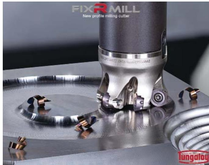
FixRMill využívá kruhové destičky pro obrábění forem, záplustek a dalších komplexních dílů. Destičky jsou na zadní straně opatřeny zázezy, které zapadají do výstupků lůžka a zabraňují tak nežádoucí rotaci destiček při obrábění. Tyto zázezy nejen zabraňují otáčení destičky při velkém zatížení, ale také pomáhají obsluze správně využít celou řeznou hranu destičky.
