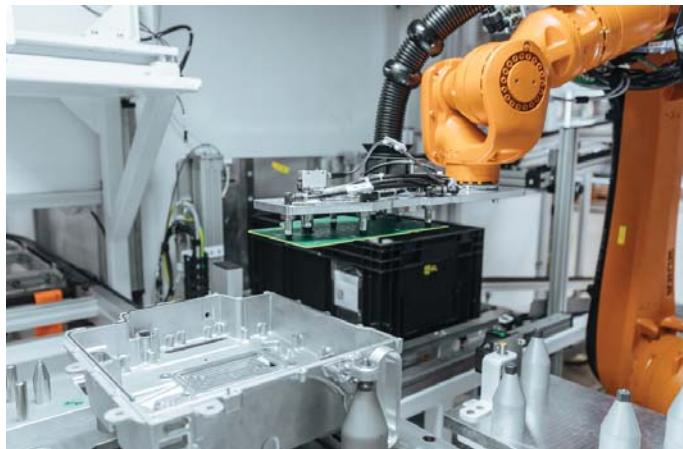
Precizní montáž: KR CYBERTECH vkládá vnitřní elektronické prvky do krytu řídící jednotky elektromobilu.
