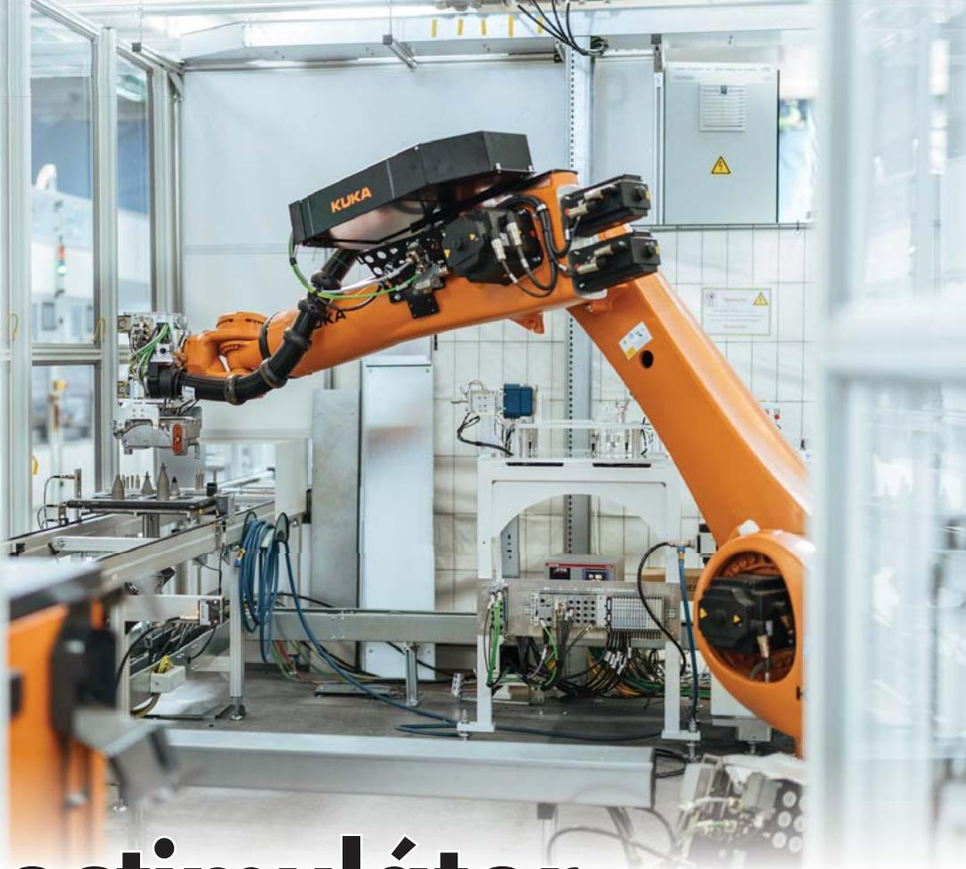
Nejdříve monitáž, pak kontrola: robot KUKA KR QUANTEC kontroluje řídící jednotky elektromobilu.
