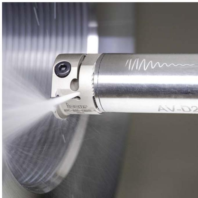
Obr. 3 Antivibračná tyč AV-D z radu WHISPERLINE pre vymeniteľné adaptéry
