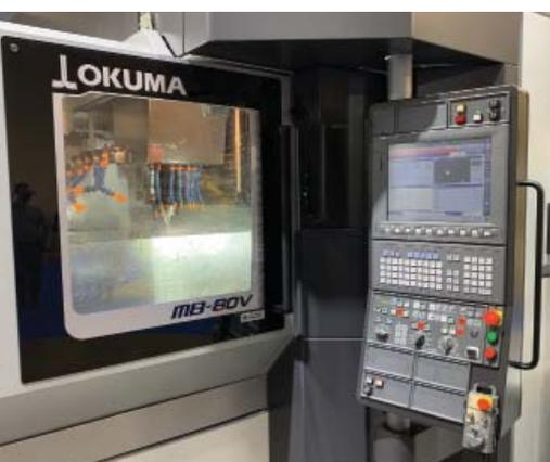
Vďaka paletovej výmene systému oplachu triesok z pracovného priestoru s integrovanými širokými lamelovými dopravníkmi dosahuje maximálne využitie kapacity stroja.
