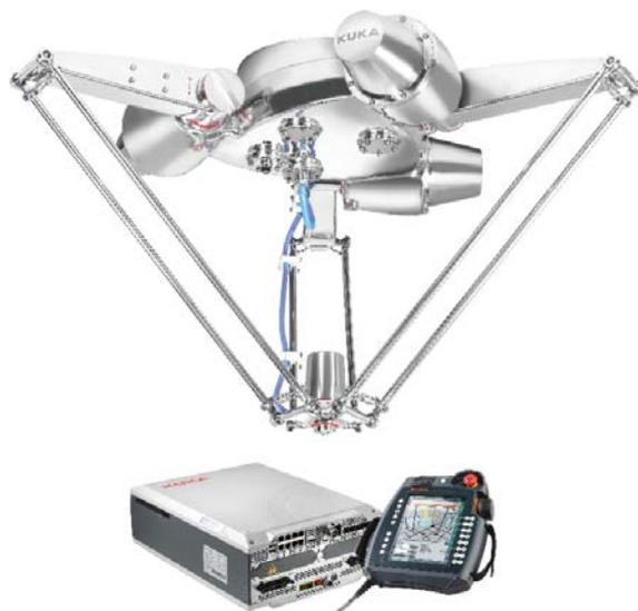
robota a IP 69K pro osu 4, se velmi snadno čistí a dezinfikuje – dokonce i při použití vysokotlakého čističe s tlakem až 100 kPa. Současně vyhovuje nejpřísnějším požadavkům potravinářského průmyslu. Robot KR DELTA bude mít od svého uvedení na trh certifikaci TÜV o splňování norem Úřadu pro kontrolu potravin a léčiv USA a Německého kodexu pro potraviny a krmiva.
