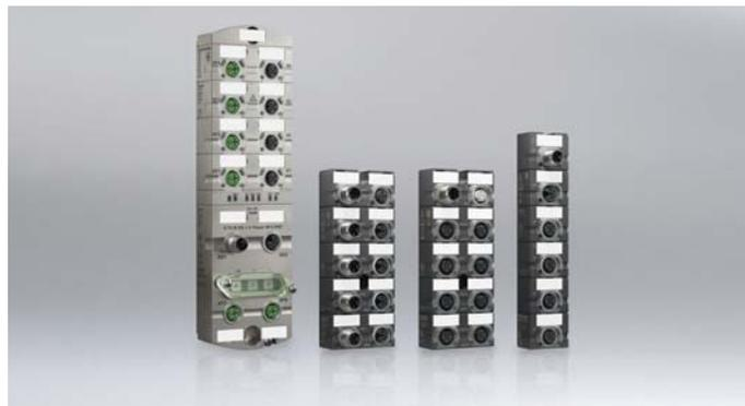
Inštalačné riešenia Vision od Murrelektronik (zľava doprava): Xelity Hybrid Switch preberá dátovú komunikáciu a prúdové napájanie, Injection Box je štvornásobný 24 V napáťový a signálový napájač, Master Breakout Box rozvádza napätie a signály a NEC Class 2 Splitter je čisto napáťovým a signálovým rozbočovačom.
