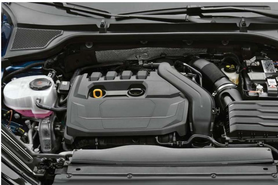
V niektorých modeloch ŠKODA z recyklátov vznikajú exteriérové kryty podvozku, podbehy kolies, prípadne aj odvodňovací kanál pod čelným sklom, ktorý vidno na fotografii.
