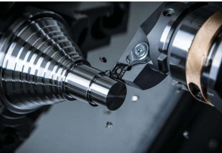
Ať už potřebujete obrábět austenitické nerezové oceli nebo vysoce legované oceli, pro každou aplikaci má Ceratizit ve svém portfoliu optimální břitovou destičku. Vývoj byl zaměřen na nejčastěji používané nerezové oceli V2A (např. 1.4301) a V4A (1.4545) s cílem poskytnout uživateli širší výběr břitových destiček, které dokonale a bezproblémově pokryjí každou aplikaci – od hrubování až po jemné obrábění.
