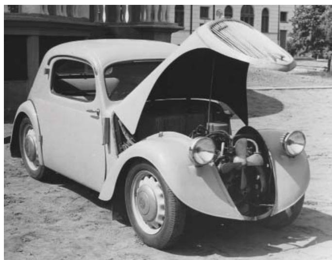
Čtyřdobý vzduchem chlazený vidlicový dvouválec SV před přední nápravou je originální konstrukcí ŠKODA. Z objemu 844 cm<sup>3</sup> dával výkon 15 k (11 kW), poháněl zadní kola. ŠKODA SAGITTA vážící jen 580 kg jezdila až 70 km/h.
