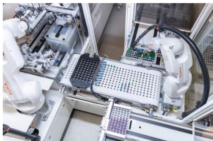
Dva roboti KUKA typu KR 3 AGILUS a KR10 AGILUS jsou instalovány v robotické buňce.
