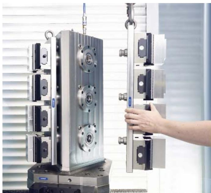
Pomocou upínacieho systému s nulovým bodom SCHUNK VERO-S možno opäťovné osadenie upínacích veží vykonávať rýchlo a presne.
