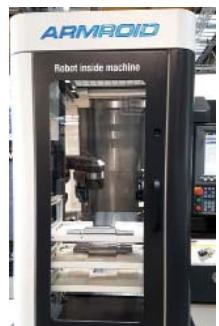
ARMROID je kĺbové rameno robota priamo integrované do oblasti obrábania, čo umožňuje automatizáciu a podporu procesu obrábania.
