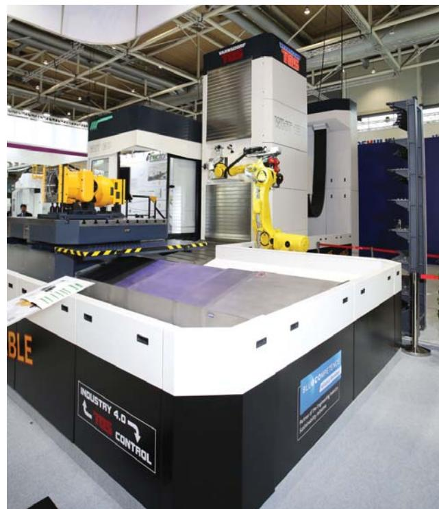
přichází na trh s novinkou ve svém výrobním programu nebo nabídce služeb. Na letošním veletrhu obráběcích strojů EMO v Hannoveru předvedla žhavou novinku - stroj WHT 130 v konfiguraci vodorovná vyvrtávačka, vybavený robotickou výměnou nástrojů.
