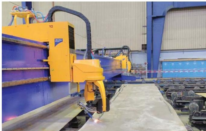
Obr. 4 Technologicky náročné rezanie tenkého zvlneného panelu úkosovou hlavou s kyslikovým plameňom (Nemecko)
