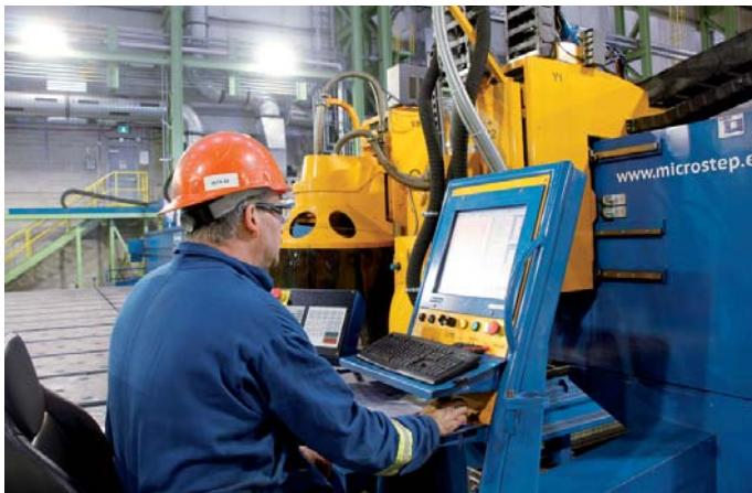
Obr. 3 Pojazdný operátorský stand portálu veľkoplošnej panelovej linky s riadiacou konzolou s ovládaním pomocou dotykovej obrazovky (Kanada)
