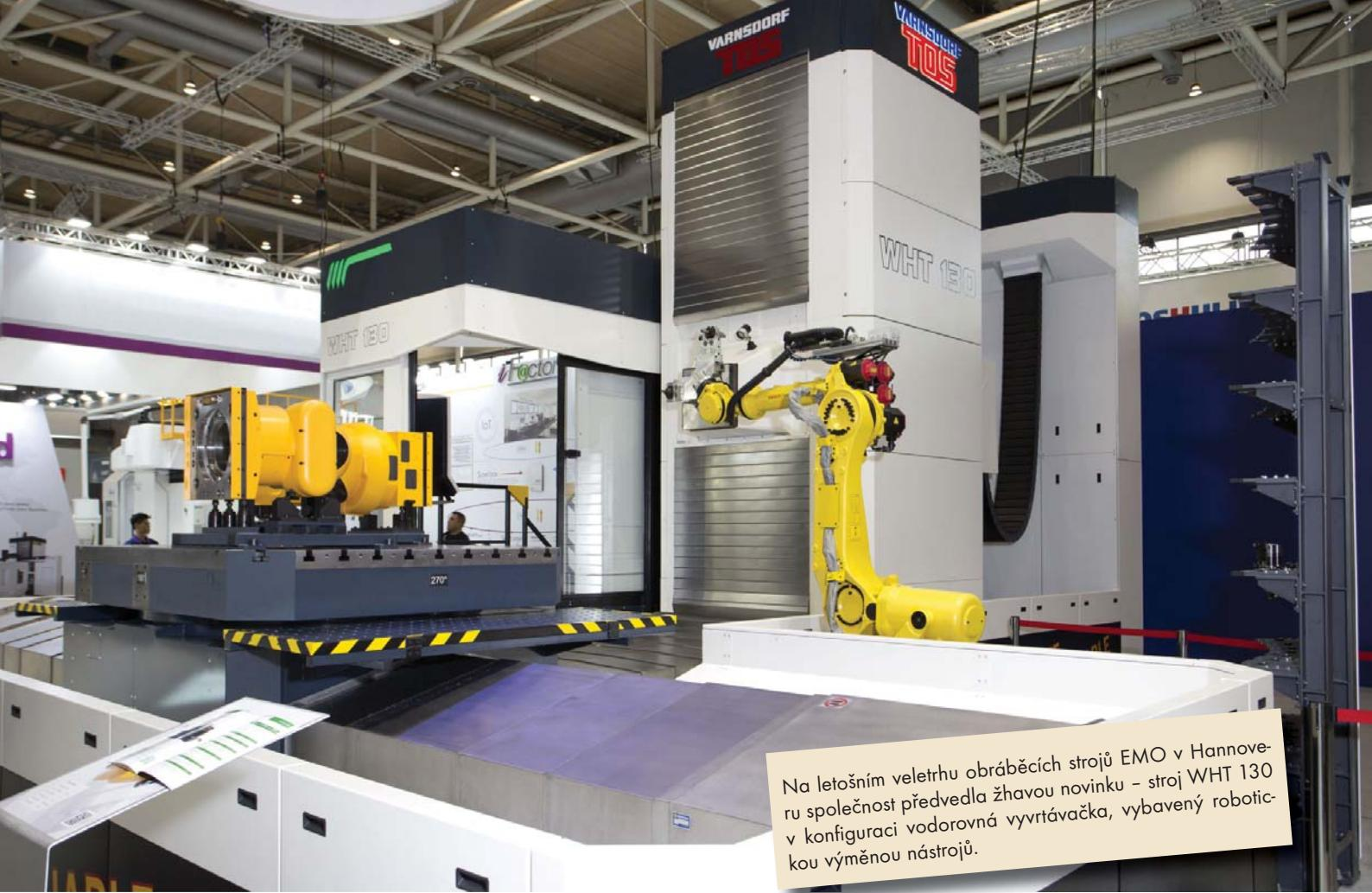
Na letošním veletrhu obráběcích strojů EMO v Hannoveru společnost předvedla žhavou novinku – stroj WHT 130 v konfiguraci vodorovná vyvrtávačka, vybavený robotickou výměnou nástrojů.
