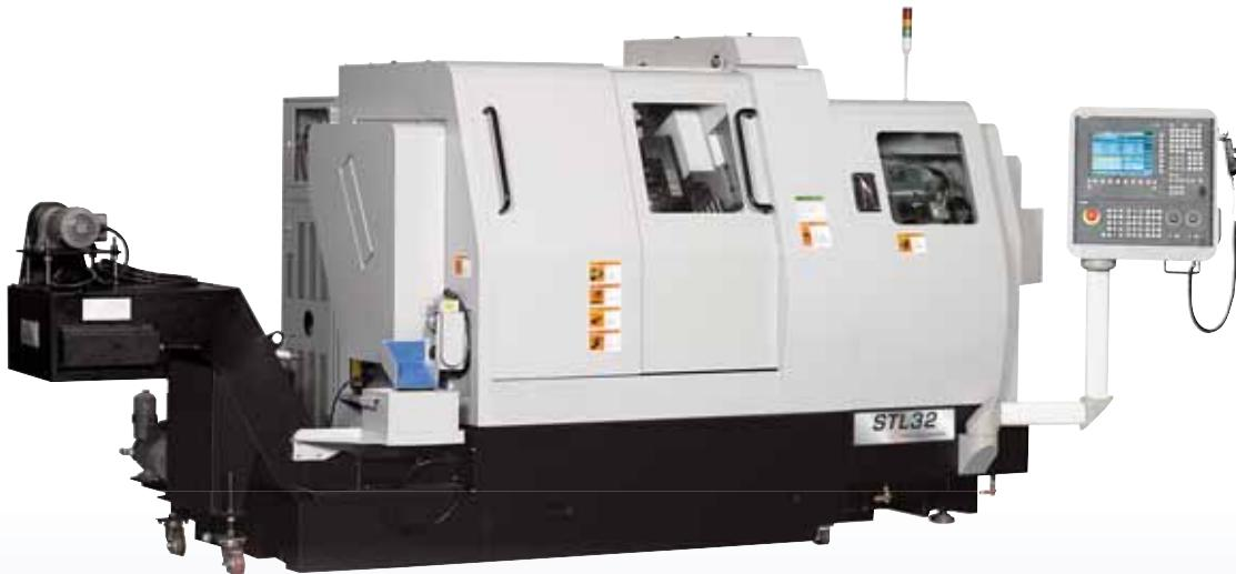
Precizní stroje HANWHA jihokorejského výrobce dlouhotočných automatů jsou strojírenské veřejnosti mnoho let dobře známy. Stroj pod označením STL38H(Y3) – aktuálně nejvýkonnější tříkanálový revolverový 12-osý soustružnický systém.
