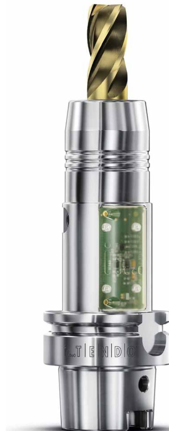
Inteligentný upínač iTENDO umožňuje monitorovanie a reguláciu procesu v reálnom čase priamo na nástroji. Geometrické a výkonové parametre upínačov nástrojov zostávajú aj pri použití senzorov nezmenené.
