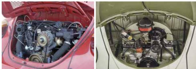
Obr. 10 Motor rokmi rásťol nie len zdvihovým objemom, ale aj veľkosťou pod kapotou (motor z roku 1958 a 2000) [11], [14]
