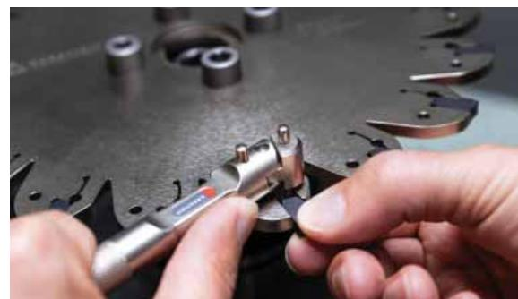
Montáž a demontáž břitových destiček pomocí unikátního klíče převzatého ze systému SX.
