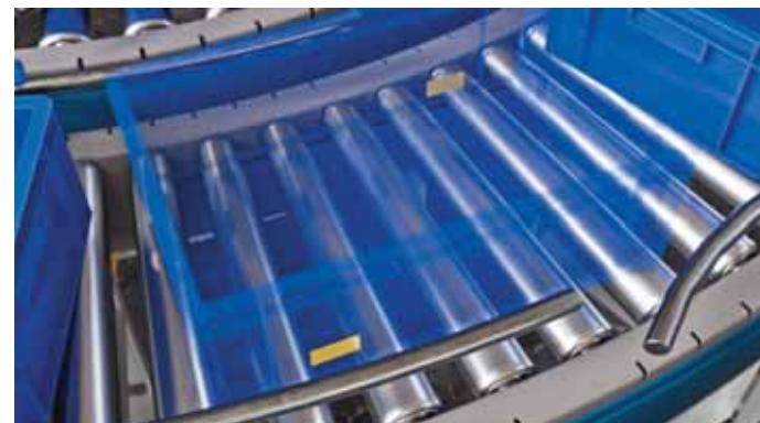
RFID štítky prilepené diagonálne na opačných stranach zaistujú, že aspoň jeden štítok je v dosahu čítačky, čo vede k trvalo optimálnym výsledkom čítania.
