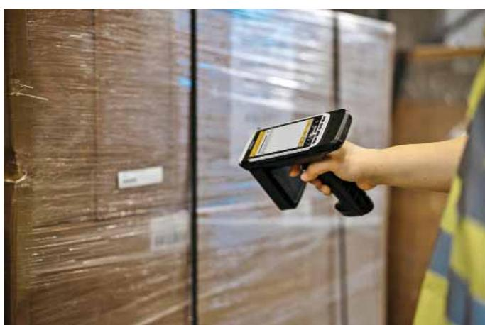
Ručné čítačky RFID sú ideálne na čítanie pohybujúcich sa štítkov a v procesoch, ktoré sa nedajú ľahko automatizovať čítačkami umiestnenými na dopravníkových pásoch, bránach alebo vysokozdvížnych vozíkoch.
