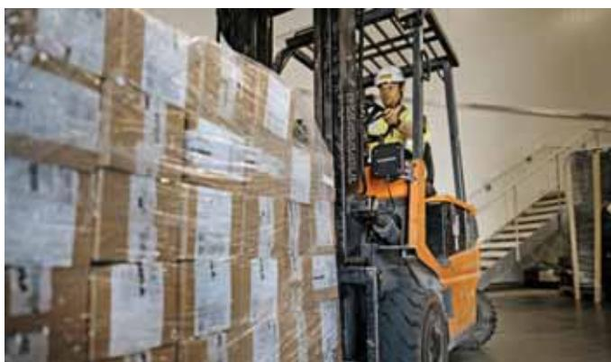
Vysokozdvižné vozíky vybavené RFID čítačkami umožňujú spoľahlivú a rýchlu identifikáciu paliet a kontajnerov.
