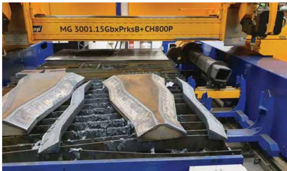
Obr. 4 Výhody dodatočného úkosovania plameňom – minimálny odpad, hladký povrch rezu, presná kontúra aj pri veľkých uhloch – dobre demonštrujú diely hrúbky 90 mm s Y profílom rezu so 60° úkosom (Južná Afrika).
