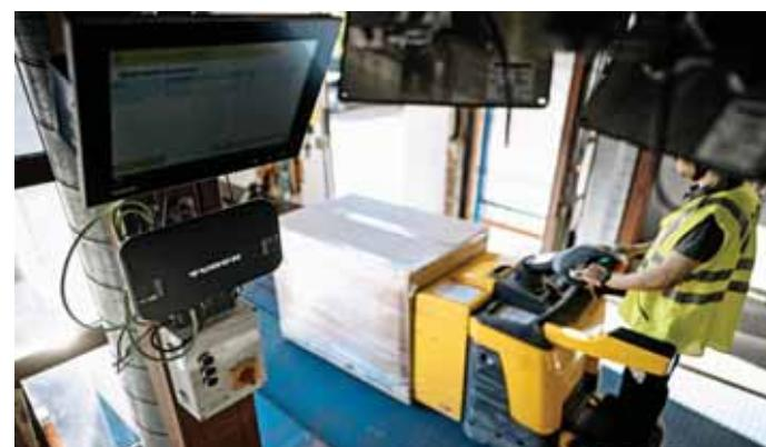
Čítačky RFID sú navrhnuté na čítanie viacerých štítkov RFID súčasne – paleta s RTI sa pohybuje cez bránu.
