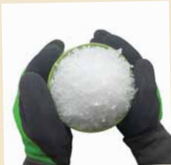
Okrem čistenia otryskávaním sa suchý ľad využíva ako médium na chladenie potravín pri preprave. V tom prípade sa granulát suchého ľadu väčšej frakcie (9 - 12 mm) sa balí do perforovaných vrecúšok. Vďaka postupnému uvoľňovaniu chladu dokáže potraviny udržať dlho čerstvé - efektívne, hygienicky a bez energetických nárokov.
