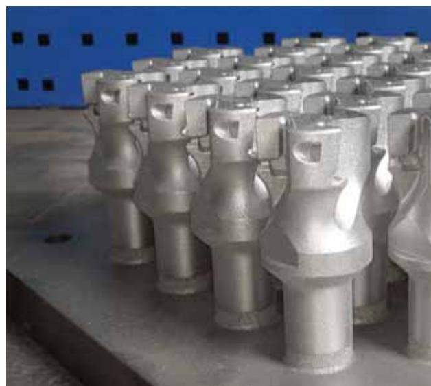
3D tlač kovov – funkčný prototyp telesa frézy, vrátane zložitého tvaru lôžka, vyrobený laserovou technológiou využívajúcou kovy vo forme prášku.
