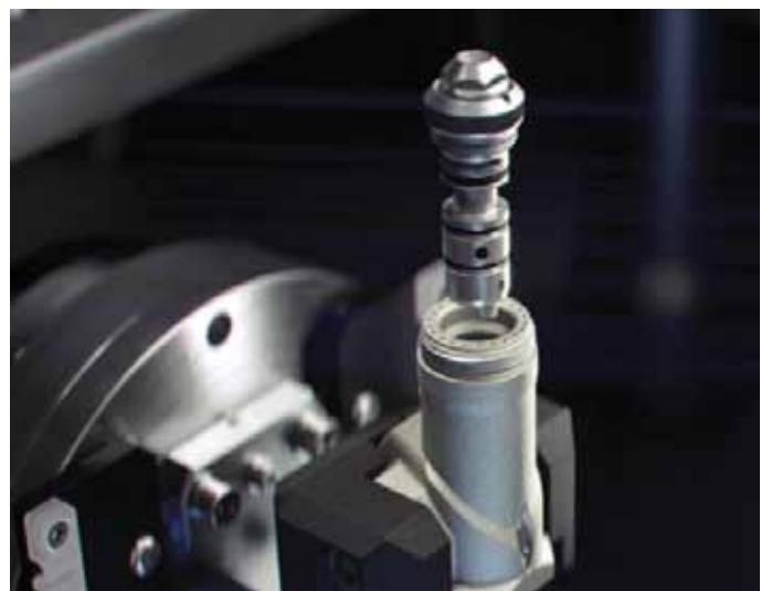
Společnost GF Machining Solutions nabízí jako první výrobce na světě možnost pracovat na strojích řady CUT X s otevřenými nebo uzavřenými vodítky; umožňuje to rychlý a jednoduchý systém výmenných kazet.
