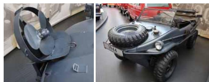
Obr. 8 Obojživelník KdF Schwimmwagen a sklopná lodná vrtuľa (foto: M. Fabian)
