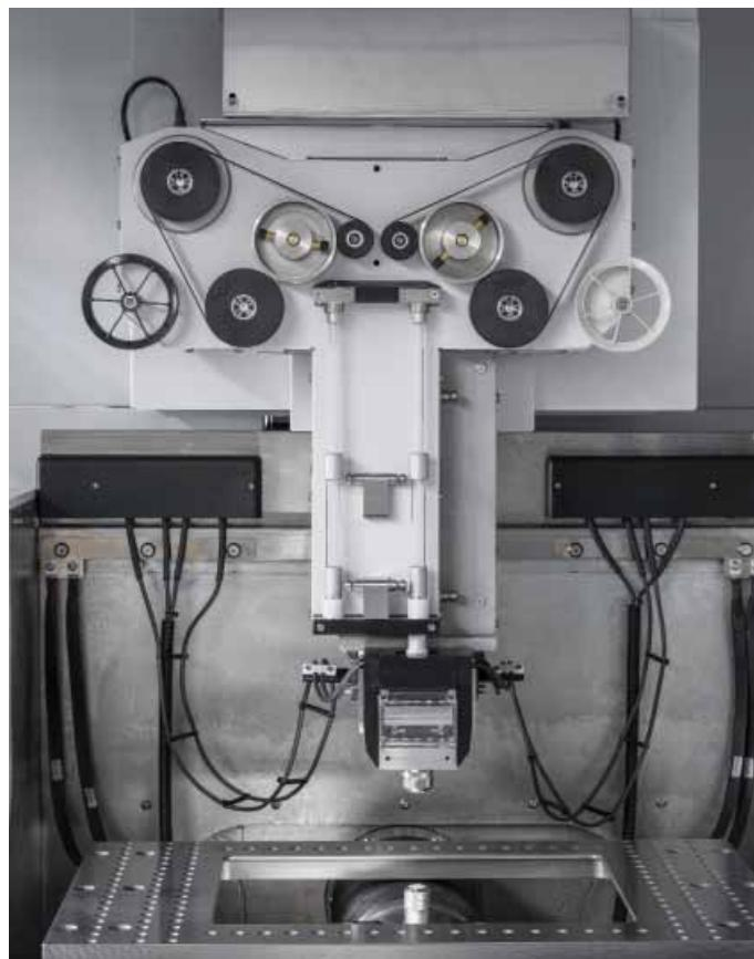
Stroj CUT X má dva identické a symetrické systémy vedení drátu pro jednoduché a rychlé hrubování i dokončovací práce, optimální rychlosť a presnosť rezu a delší samostatný provoz.
