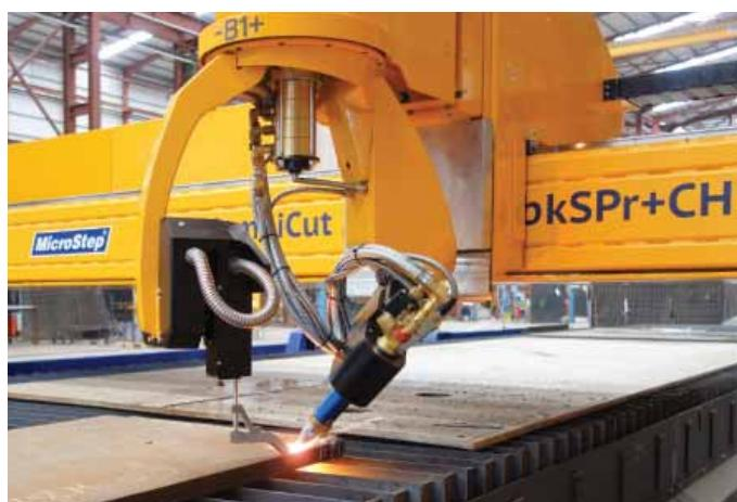
Obr. 1 Kyslíkový rotátor na kombinovanom plazmovo-kyslíkovom stroji CombiCut (Španielsko)
