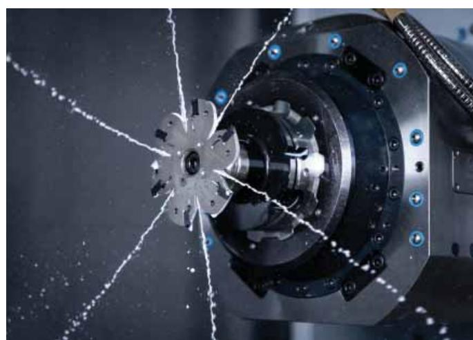
Kotoučové frézy MaxiMill - Slot-SX pro frézování drážek jsou novou produktovou řadou v programu CERATIZIT.
