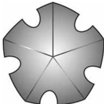
Asymetrická polygónová geometria a zvýšený počet tlakových kanálov prispievajú k optimálному prevodu sily.
