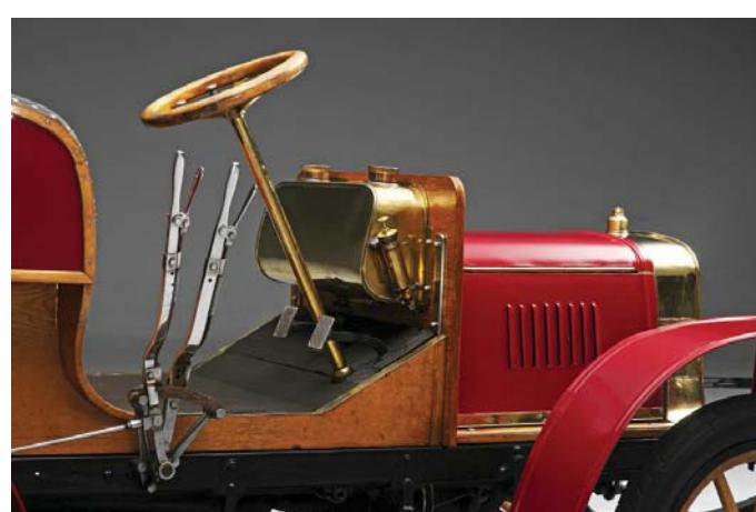
Ručné páky spojené lankom s bubnami zadných kolies pomáhali s brzdením
