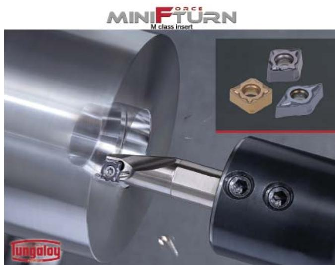
Soustružnické destičky MiniForce-Turn s oboustrannou pozitivní geometrií mají unikátní rozhraní pro bezpečné upnutí. Další výhodou je také jejich vysoká tuhost a mimořádná hospodárnost oproti standardním jednostranným pozitivním destičkám.
