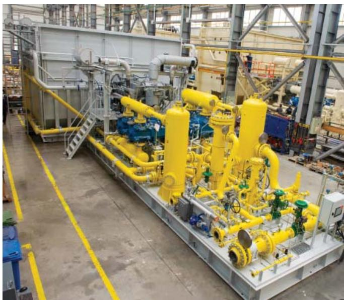
Obr. 1 Dvojstupňový kompresorový agregát Ariel KBK4 od firmy Euro Gas Systems, pri výrobe ktorého je naplno využitý potenciál multifunkčného rezacieho centra
