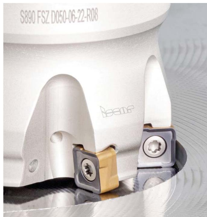
Obr. 1 Fréza S890 FSZ D050-06-22-R08 z radu NEODO so štvorcovými obojstrannými hrubovacími doštičkami s integrovaným hladiacim britom
