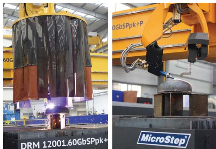
Obr. 4 Úkosové rezanie menšej kupoly plazmou (vľavo) a kyslíkovým plameňom (vpravo). Stroj dokáže rezať kupoly do priemeru Ø 2 000 mm a výšky 600 mm
