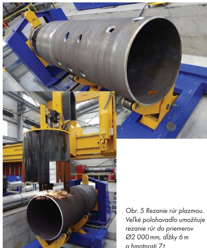
Obr. 5 Rezanie rúr plazmou. Veľké polohovadlo umožňuje rezanie rúr do priemerov Ø 2 000 mm, dĺžky 6 m a hmotnosti 7 t
