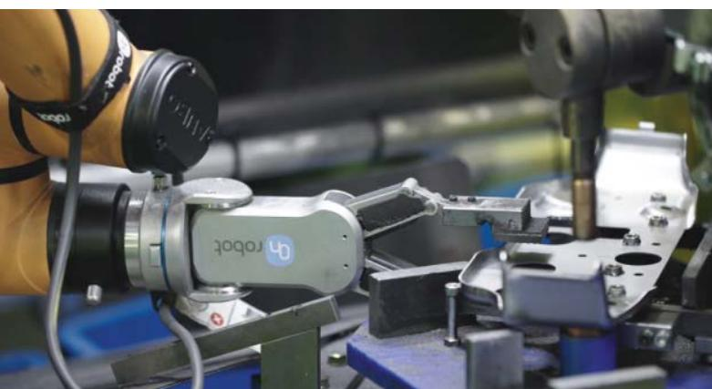
Uchopovač OnRobot RG2 v kombinácii s robotickým rámom značky AUBO pomohol automatizovať dovtedy manuálne procesy obsluhy strojov na razenie dielov. Kolaboratívna aplikácia nevyžaduje mnoho miesta ani špeciálne zábrany a umožňuje pracovníkom pracovať v tesnej blízkosti kobota. Pracovníci teraz navyše nemusia stáť hodiny pri strojoch a môžu sa venovať ďalším úloham.
