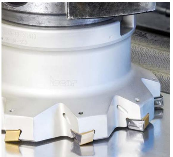
Obr. 3 Čelná fréza TANGFIN HTF-R-LN10 pre tangenciálne upnuté doštičky HTP LN 1006 pre superdokončovanie
