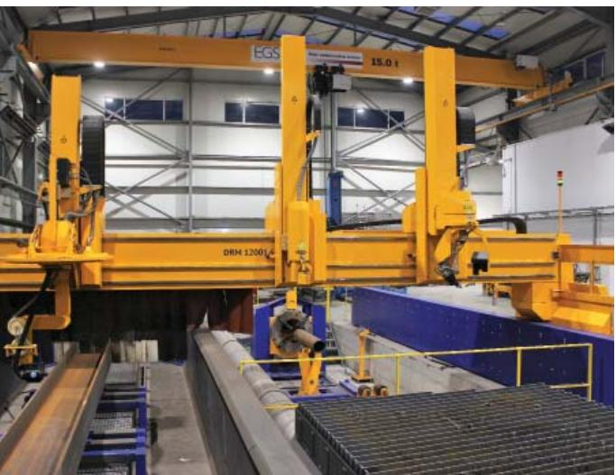
Obr. 2 Portál stroja v EGS s tremi technologickými suportami a tremi pracovnými zónami – rezanie otvorených profilov (vľavo), rezanie plechov a kupol (vpravo vpred) a rezanie rúr (vpravo vzadu)
