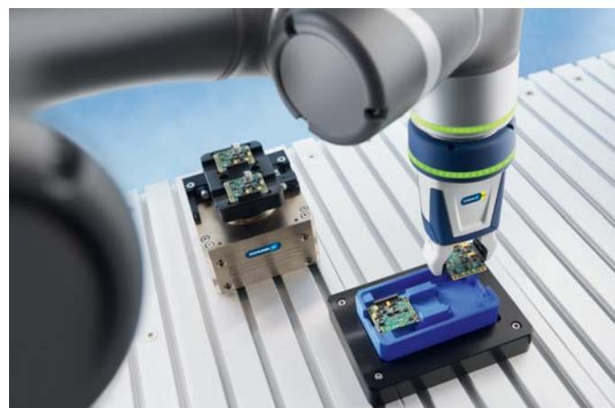
Novinka z radu Plug & Work od spoločnosti SCHUNK: Perfektne zladené uchopovače a systémy rýchlej výmeny pre coboty od spoločností OMRON and FANUC.
