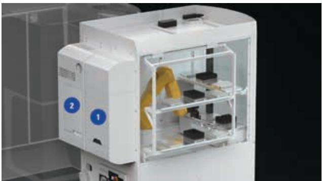
Robotický zakladač s vnějšími moduly k čištění (1) a laserovému popisování nástrojů (2)
