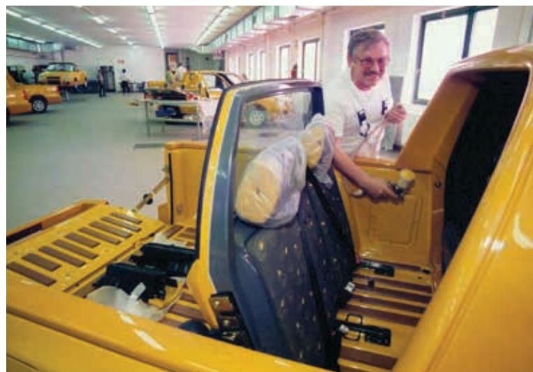
ŠKODA FELICIA Fun nabízela praktický „party trik“, rozvíjející princip vyzkoušený již v prototypech FAVORIT Fun: výklopou a posuvnou zadní stěnu dvoumístné kabiny, rozšiřující obsaditelnost o dvě další místa.
