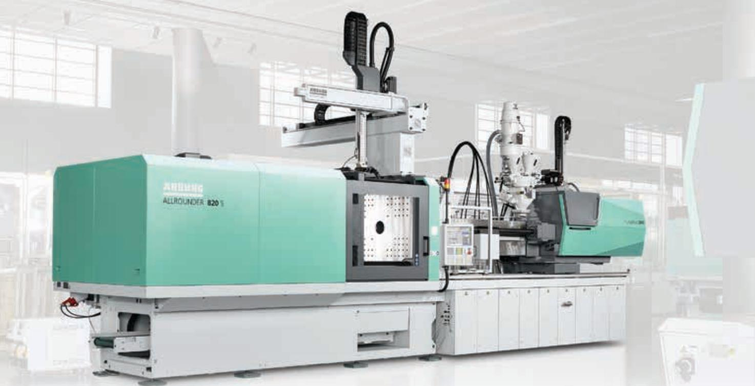
Vstříkovací stroj pro technologii FDC: Přímé dávkování dlouhých vláken do taveniny umožňuje efektivní výrobu konstrukčních dílů.
