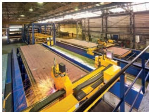
Obr. 1 Integrácia plazmových rezacích strojov MicroStep s automatickým výmenníkom rošťov (miesto inštalácie: Holandsko)
