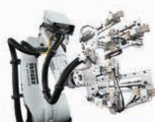
Projekt odlehčené konstrukce Fupro: Pro automatizovanou výrobu pilotního projektu „Zádová opěrka“ vyvinula společnost Arburg speciální chapadlo pro manipulaci a tvarování „organoplechu“ a jejich vkládání do formy.
