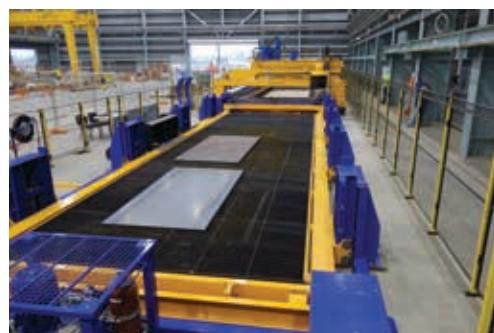
Obr. 2 MicroStep MSLoop - systém presuvných rošťov rezacieho stroja s oddelenými zónami nakládky polotovarov a vykládky hotových dielov, ktorý umožňuje vykonávanie nakládky, vykládky a rezania ako nezávislé paralelné procesy (miesto inštalácie: Austrália)
