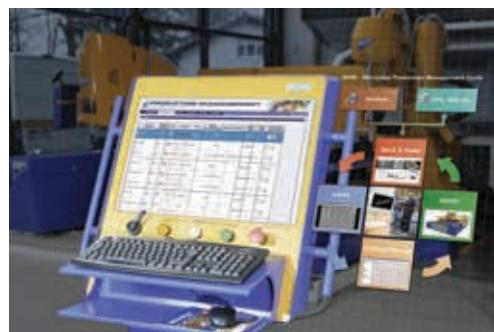
Obr. 3 CAPP systém Machine Production Management (MPM) od MicroStep-u je nadstavbovým systémom na správu databáz polotovarov a objednávok a ich prepojenie s CAM softvérimi a riadiacim systémom rezacieho stroja; zároveň zabezpečuje napojenie na ERP systém
