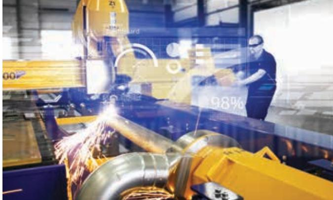
Obr. 4 Moderné riešenia strojov so zabudovanými komplexnými senzorickými systémami jednotlivých uzlov a úrovni stroja umožňujú prehľadné zobrazovanie prevádzkových údajov v reálnom čase formou tzv. dashboardov, ktoré sú sprístupnené vedúcemu výroby, ktorý tak získa prehľad o celkovom stave prevádzky a môže efektívnejšie riadiť/plánovať výrobu
