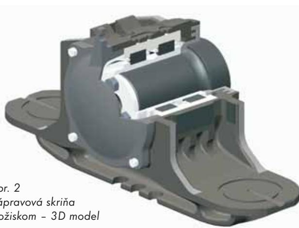
Obr. 2 Nápravová skriňa s ložiskom - 3D model
