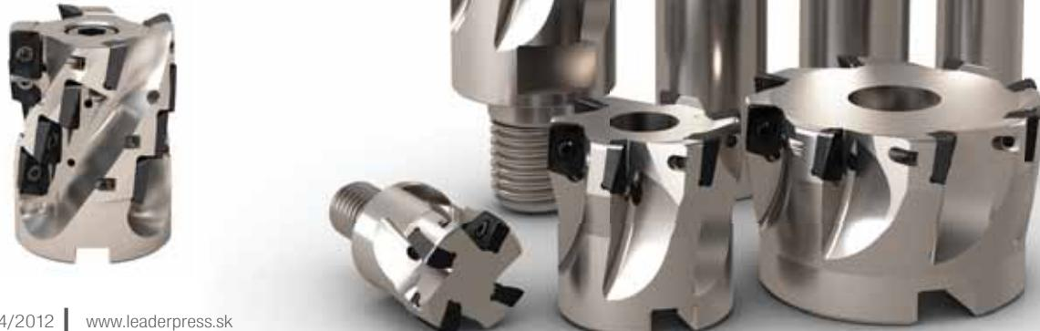
Frézy radu TURBO majú kalené teleso s povrchovou tvrdosťou 700 HV, a tiež povlak z niklu. Výsledkom je nástroj s vysokou presnosťou, oteruvzdornosťou a odolnosťou voči korózii, a tiež s malým sklonom k nalepovaniu triesok na teleso frézy v ťažkých podmienkach.
