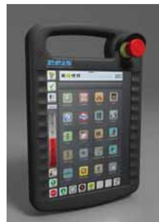
Obr. 5 Nový obslužný panel ReisPAD s intuitivním konceptem obsluhy.
