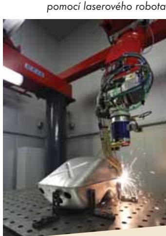
Obr. 3 Laserové svařování pomocí laserového robota
