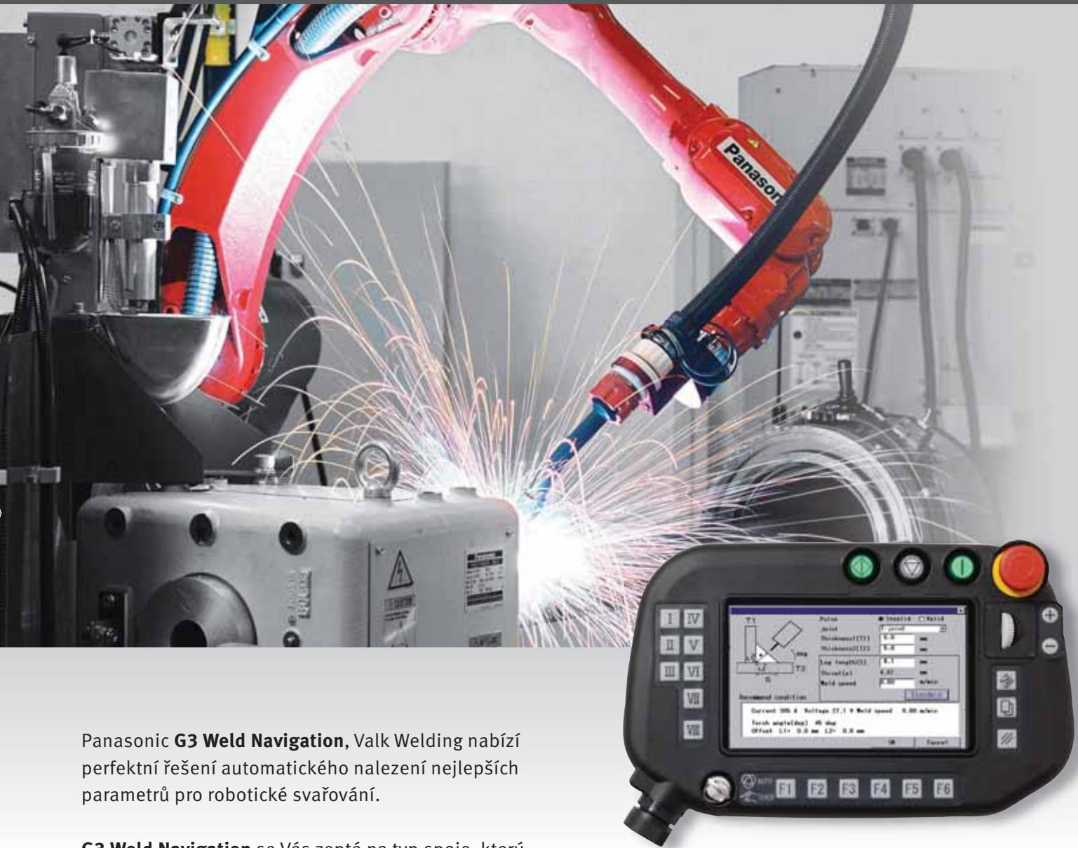
Panasonic **G3 Weld Navigation**, Valk Welding nabízí perfektní řešení automatického nalezení nejlepších parametrů pro robotické svařování.
