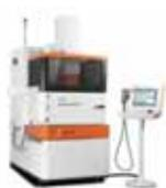
Hloubička FORM 20 je vybavena křížovým stolem s rozjezdem 350 x 250 mm a velikostí stolu 400 x 630 mm, lineárním zásobníkem elektrod a upínací hlavou System 3R (Macro) nebo EROWA (ITS 50). Stroj je vybaven odměřovacími pravítka pro dosažení vysoké přesnosti. FORM 20 přináší uživatelům vysokou spolehlivost, konstrukční řešení s malou podlahovou plochou, ergonomické ovládání, perfektní kvalitu povrchu a vynikající rychlosť obrábění. To vše ve švýcarské kvalitě.
