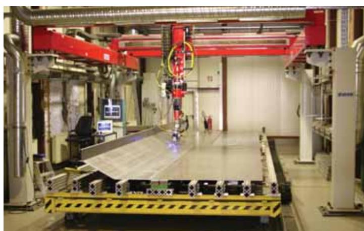
Obr. 4 Laserový portálový robot Reis ke svařování velkoobjemových dílů při současné vyšší preciznosti.
