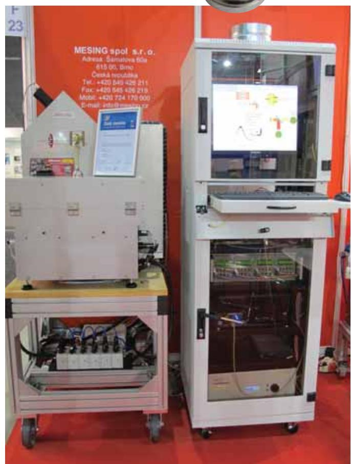
Obr. 1 Automatické bezkontaktní měřidlo na koncové měrky
