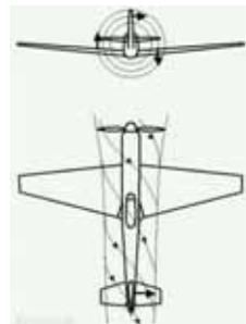
Obr. 2 Skruškovicové stáčanie pri vrtuľovom motore [1]
