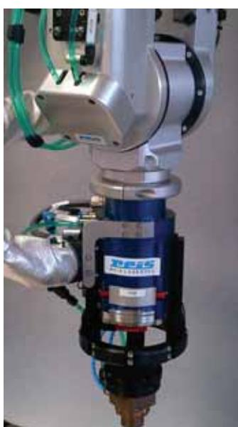
Obr. 2 Laserová svařovací optika MWO Reis Lasertec
