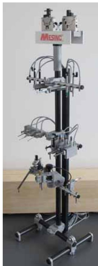
Obr. 2 Sada nových indukčnostních snímačů
