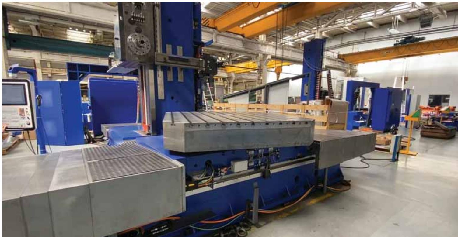
Ze vzdálené přejímky stroje WHQ 13 CNC (test otočného stolu).
