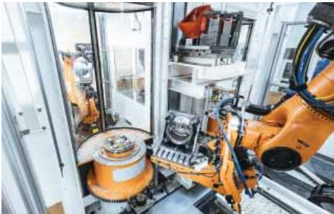
Robot KUKA automaticky presúva diely z obrábcieho stroja do bunky pre dodatočné opracovanie kovových častí.
