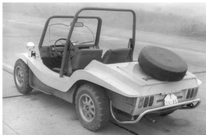
Minimalistické provedení interiéru usnadňovalo jeho údržbu v náročných provozních podmínkách. Do vozu bez dveří se nastupovalo přes zvýšené vyztužené prahy. Posádku chránila nasazovací textilní střecha a postranice s průzory.
