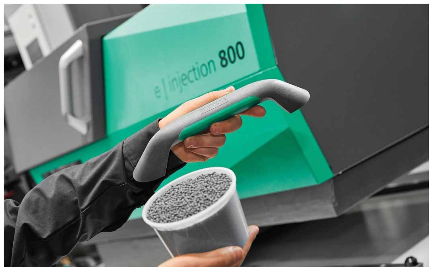
Elektrický dvoukomponentní stroj Allrounder 630 A vyrábí rukojeť bezpečnostních dveří strojů Allrounder (materiál PCR a TPE)
