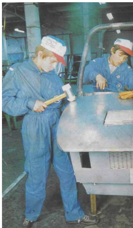
Čtyři z pěti vyrobených kusů vznikly pod zručnýma rukama mladoboleslavských učňů, v rámci jejich odborného výcviku. Prototypy měly kovovou karoserii, malosériová výroba laminátového provedení se neuskutečnila.
