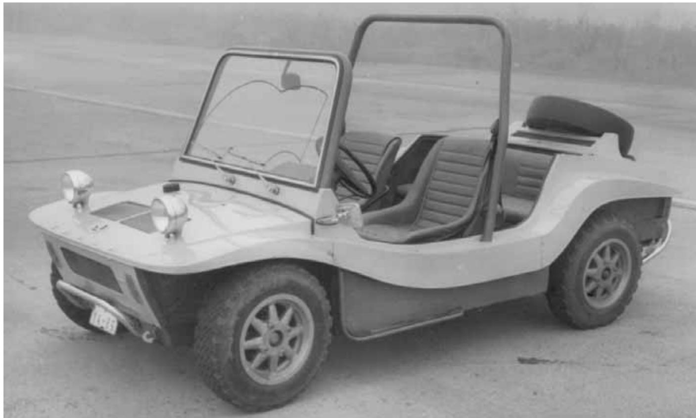
Od zahraničních vozů se ŠKODA BUGGY typ 736 z vývojového střediska AZNP lišila propracovanější konstrukcí s chladičem, akumulátorem a palivovou nádrží vpředu. Čtyřčlennou posádku chránily robustní oblouky.
