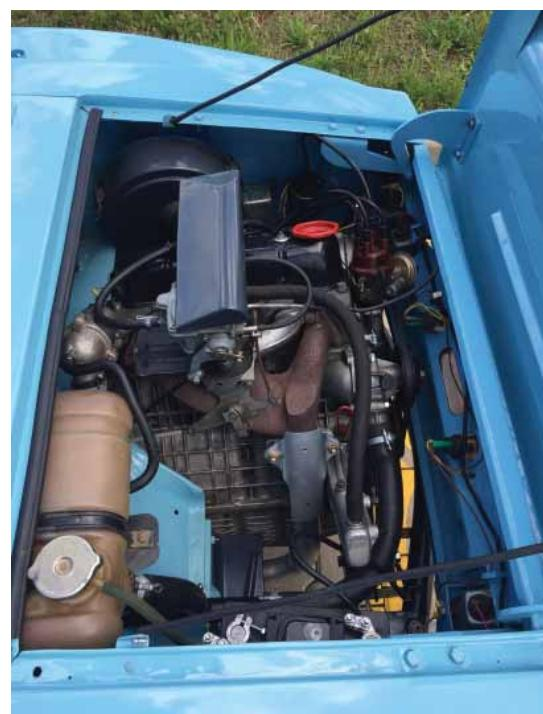
Zadní kola poháněl podélně uložený kapalinou chlazený čtyřválec ŠKODA 110 s parametry  $1107 \text{ cm}^3$ , 45 k (33 kW) při 5000 ot./min. a 74 Nm při 3000 ot./min. Buggy o pohotovostní hmotnosti 710 kg dosahovala  $107 \text{ km/h}$ .
