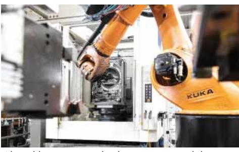
Akonáhle je proces obrábania na stroji dokončený, robot odihluje diel a položí ho na otočný stôl.
