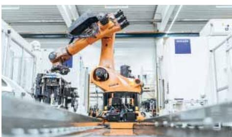
Robot KUKA je schopný pomocou pneumatického uchopovača striedavo vkladať obrobky do dvoch obrábacích centier od výrobcu Heller.
