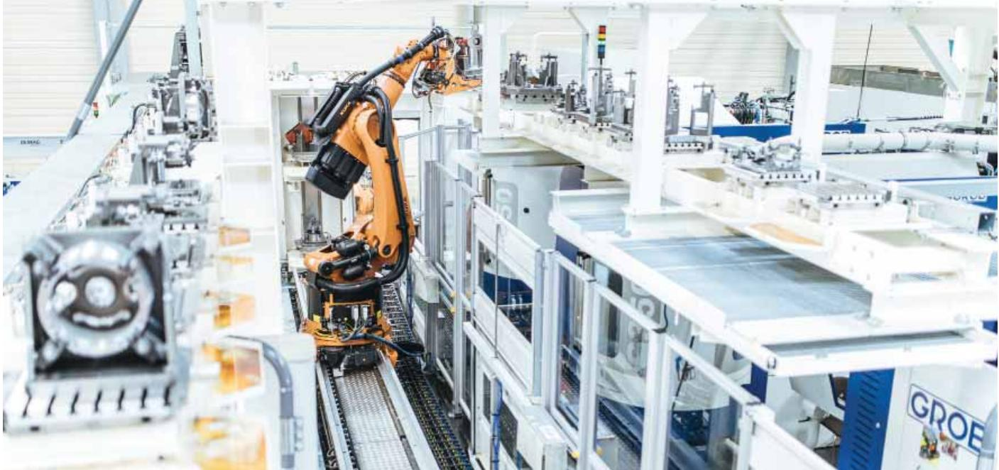
Tri obrábcie stroje od výrobcu Grob využívané na robotické obrábanie. Robot KR FORTEC, umiestnený na lineárnom pojazde sa používa pre vkladanie a odoberanie dielov.
