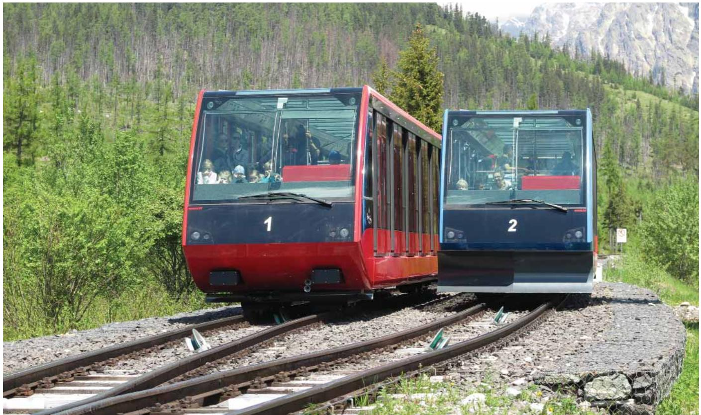
Obr. 5 Vagón č. 1 schádzajúci zhora sa miňa s vagónom idúcim hore na výhybni
