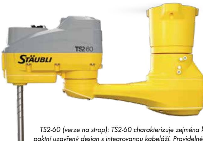
TS2-60 (verze na strop): TS2-60 charakterizuje zejména kompaktní uzavřený design s integrovanou kabeláží. Pravidelné tvary neruší žádné venkovní kabely, a tudíž zároveň odpadá riziko mechanického poškození nebo znečištění pracovního prostředí.
