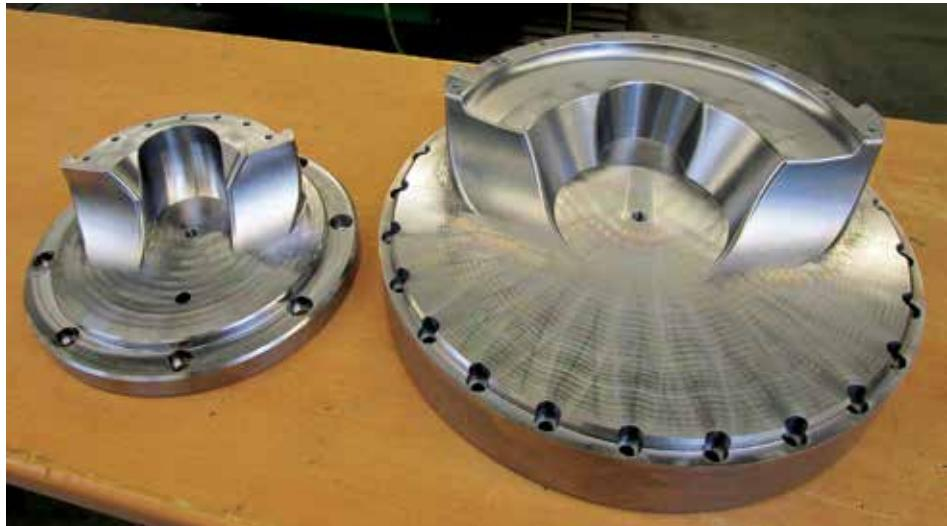
čelo, ušetrí viac ako hodinu výrobného času. Nasadili teda frézu priemeru 25 mm s duplexnou geometriou na hrubovanie a frézu typu torus D25 mm s radiúsom 1 mm na dokončovanie s oceľovou a tvrdkovovou stopkou D 25 mm.
