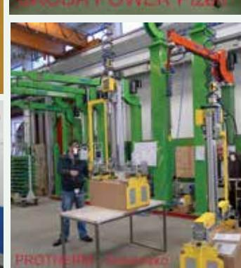
Operátor môže zdvihnuť bremeno s hmotnosťou až 320 kg jednoduchým dotknutím sa servo-ovládačej rukoväte alebo záťaže samotnej a premiestniť ho ľahkým tlakom požadovaným smerom, akoby bremeno vážilo len niekoľko gramov.
