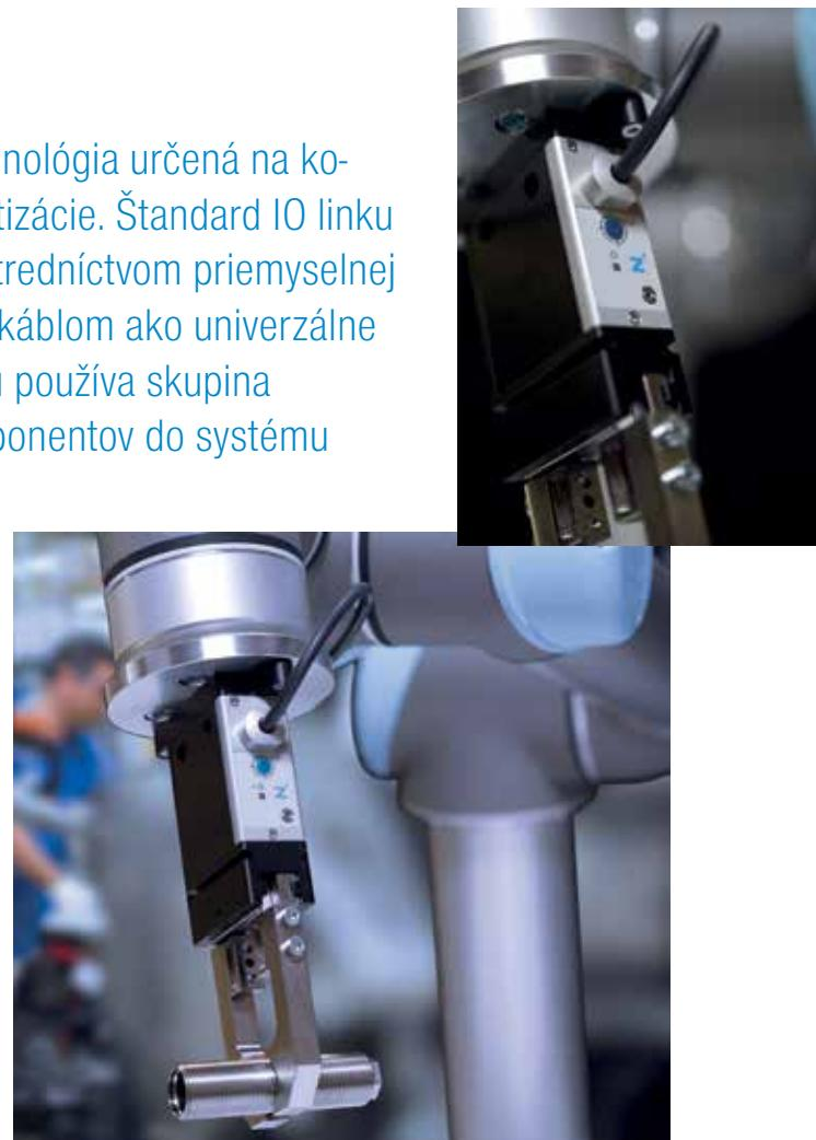
možná od najnižšej úrovne senzorov a snímačov až po najvyššiu úroveň vedenia. Analógové hodnoty sa dajú bez strát preniesť až na vzdialenosť 20 m. V spojení s aktívnym zaznamenávaním údajov je vďaka vytvoreniu dátových radov možné využiť rozšírenú diagnostiku. Takto možno vykonávať údržbu podľa potreby. Preventívnu výmenu komponentov je možné vykonať už pri prvej známke opotrebenia, dlho predtým, ako by mohlo dôjsť k výpadku.
