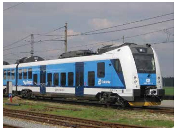
Obr. 6 Jednotka radu 441 pre jednosmernú napájaciu sústavu [6] (foto Petr Štefek)
