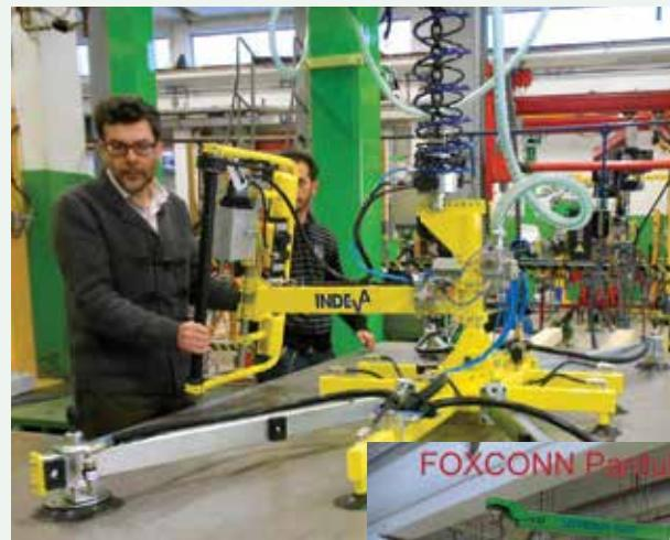
Balancéry sú elektronicky riadené systémy stáleho vyvažovania hmotnosti bremena do stavu „bezťiaže“. Umožňujú jednoduchú manipuláciu s bremenom až do hmotnosti 320 kg, pri ktorej je námaha redukovaná na minimum a bremeno kopíruje pohyb ľudského ramena.
