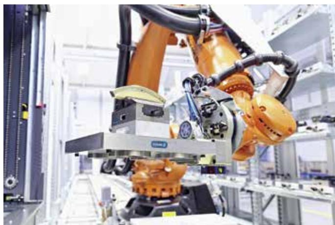
Palety s upnutými obrobkami sú uložené v úložnom priestore pre obrobky a sú automaticky nakladané do stroja.
