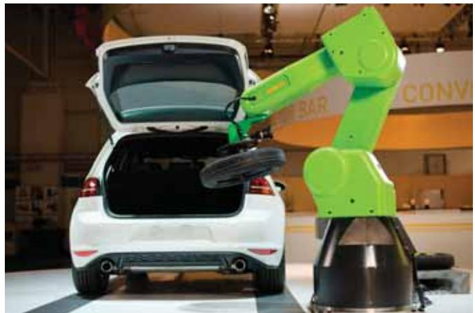
Nebezpečí úrazu omezuje kromě inteligentního systému zastavení také měkké pryžové obložení. Bezpečnost práce s robотy se s novým robotem posouvá na zcela novou úroveň. To potvrzuje také certifikát bezpečného provozu TUV ISO 10218-1, kategorie 3, který byl robotu udělen.
