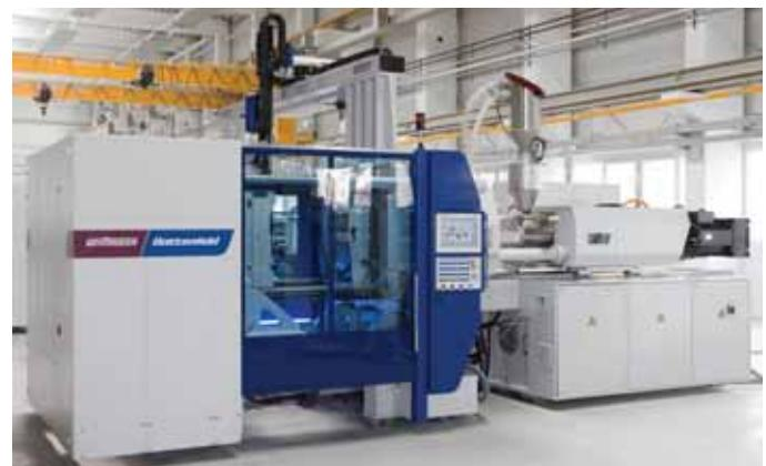
Obr. 3 Velký hybridní stroj MacroPower 450/2100 E se servoelektrickou vstříkovací jednotkou a servohydraulickou uzavírací jednotkou
