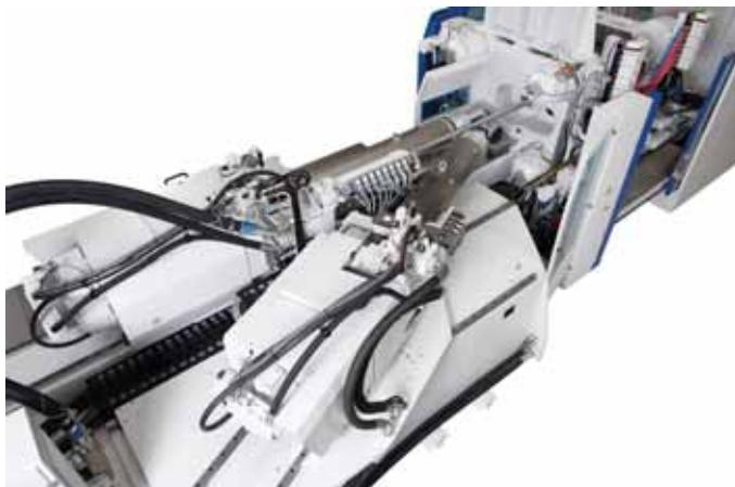
Obr. 4 Vstříkovací agregát stroje MacroPower 450/5100H/2250Y pro výrobu květináče Lechuza® sendvičovou technologií
