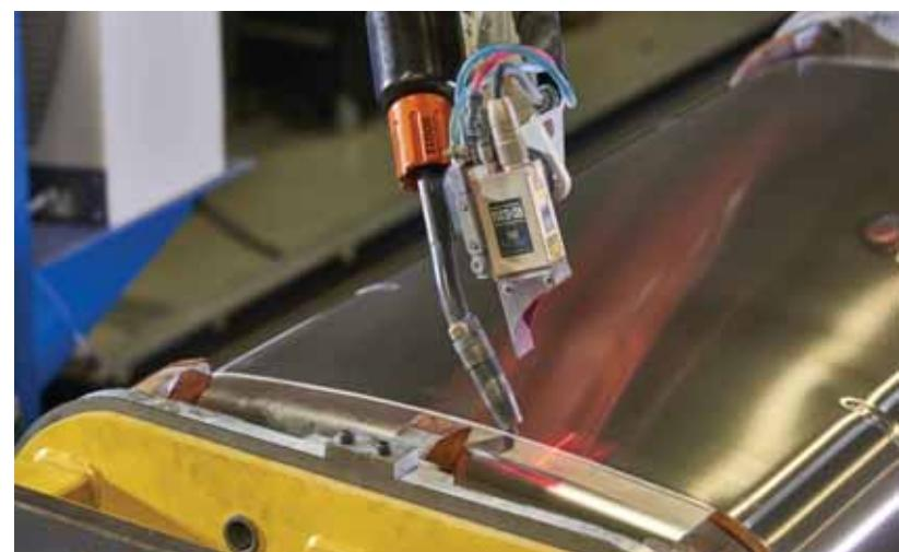
Laser-Online-Sensor CST Flex D provádí změny ihned a zaručuje výborné svařovací výsledky
