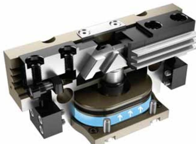
Veľká plocha oválneho piestu umožňuje PGN-plus dosiahnuť vysoké sily v kompaktnom priestore. To optimalizuje využitie sily v závislosti na veľkosti uchopovača.
