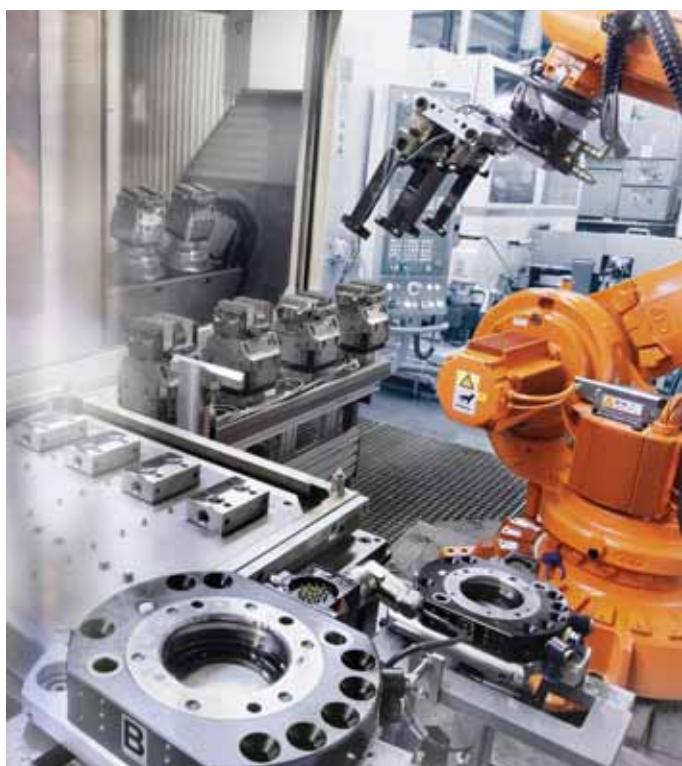
V tejto aplikácii, PGN-plus dvojnásobný uchopovač nakladá viacvretenové obrábacie centrum. S pomocou SCHUNK rýchlovýmenného systému, mechanizmus pre výmenu palety môže byť vymenený za pár sekúnd.
