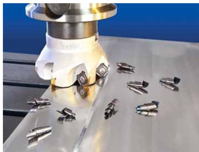
Obr. 3 Fréza systému DOVEIQMILL
