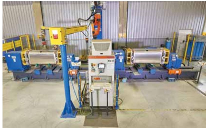
Robotické zařízení se skládá ze dvou stanic, kde se hliníkové nádrže paralelně připravují a svařují
