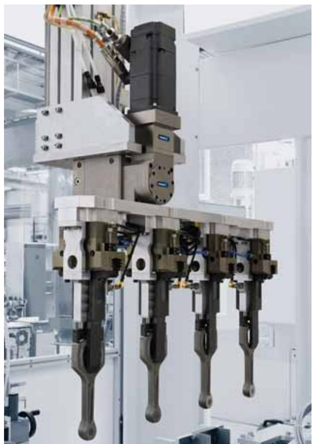
Systém pre uchopovanie ojnic kombinuje SCHUNK mechatronický ERM otočný modul s univerzálnym uchopovačom PGN-plus. Ako hybridný uchopovací systém v sebe spája robustnosť pneumatiky s flexibilitou so systémom mechatronických uchopovacích komponentov.
