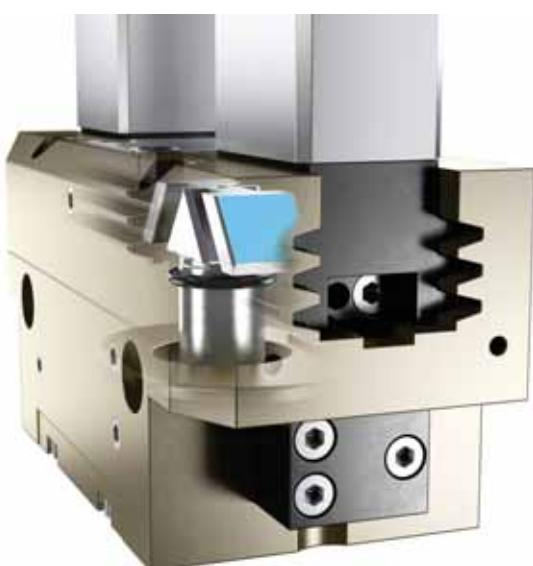
Patentované viaczubové vedenie umožňuje veľký povrch klin-háku a nízky prítlak. Prenos sily na základnú čelusť spôsobuje extrémne nízke opotrebenie.
