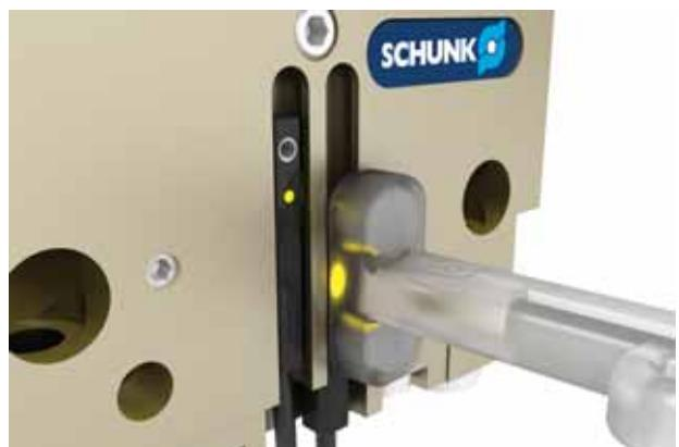
So SCHUNK MMS 22-PI senzormi je možné naprogramovať na dva spínacie body v závislosti na verzii senzorov.
