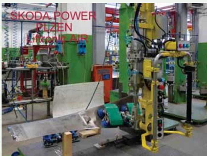
Balancéry jsou elektronicky a pneumaticky řízené systémy stálého vyvažování hmotnosti břemene do stavu „beztlíže“. Umožňují jednoduchou manipulaci s břemenem až do hmotnosti 320 kg, při které je námaha redukována na minimum a břemeno kopíruje pohyb lidského ramene.
