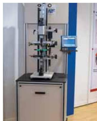
Obr. 3 – Bezkontaktní měření průměrů, ovality a házení hřídelových součástek laserovou stínovou metodou je běžné. Nicméně považujeme za vhodné upozornit alespoň na výrobky italské firmy AEROEL, které jsou přesnostními parametry nad běžným standardem; doporučujeme jejich uplatnění při bezkontaktní kontrole vysoce přesných rotačních součástek. Důkazem přesnosti i spolehlivosti jsou četné instalace zejména v italském automobilovém průmyslu.
