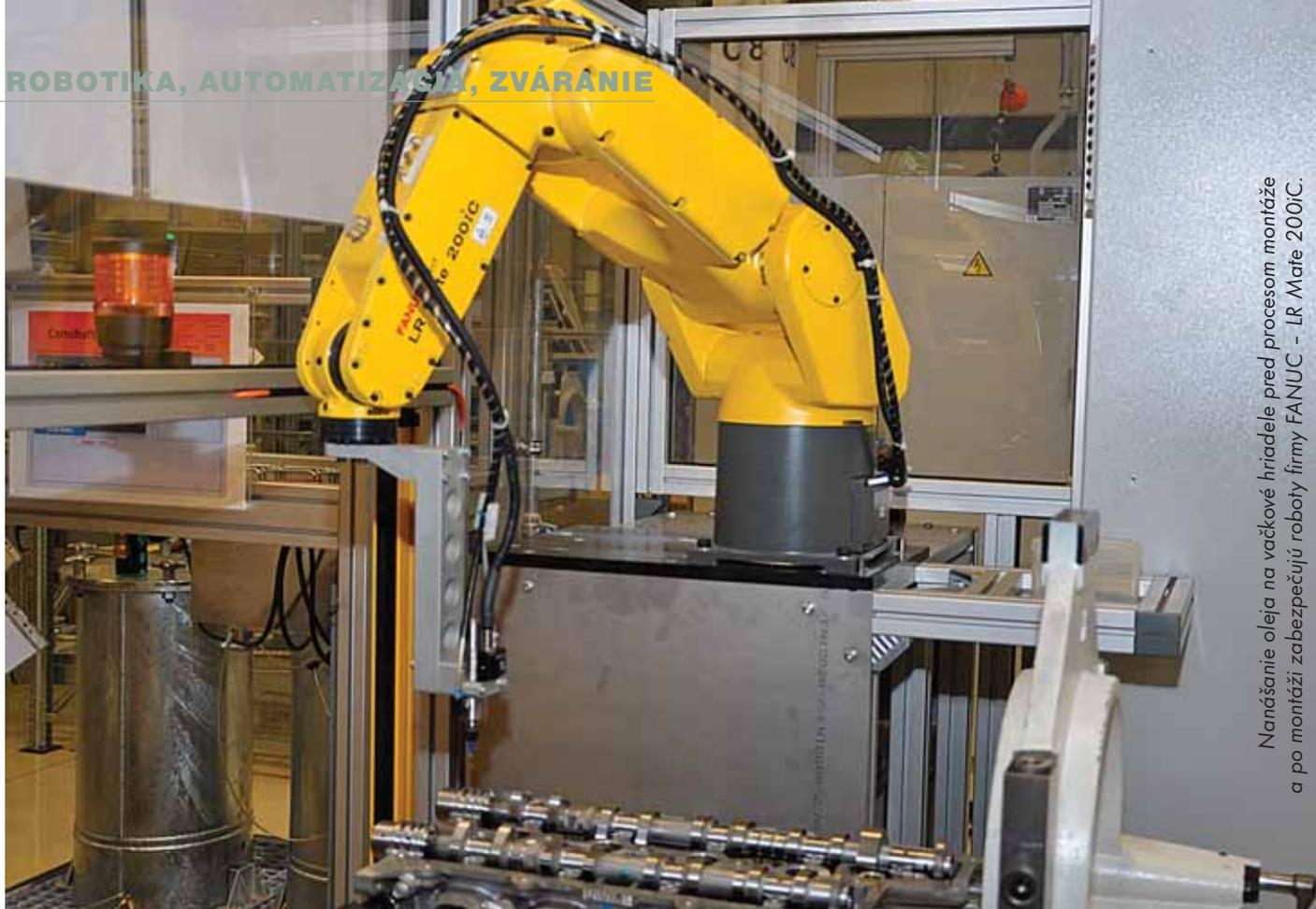
Nanášanie oleja na vačkové hriadele pred procesom montáže a po montáži zabezpečujú roboty firmy FANUC – LR Mate 200iC.
