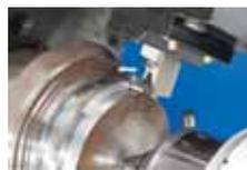
DOVE-IQ-GRIP – Nový systém nástrojov s jedinečným čelným upínacím mechanizmom pre nehatený odvod triesky, ktorý je ideálny pre hlboké a ťažké zapichovanie.
