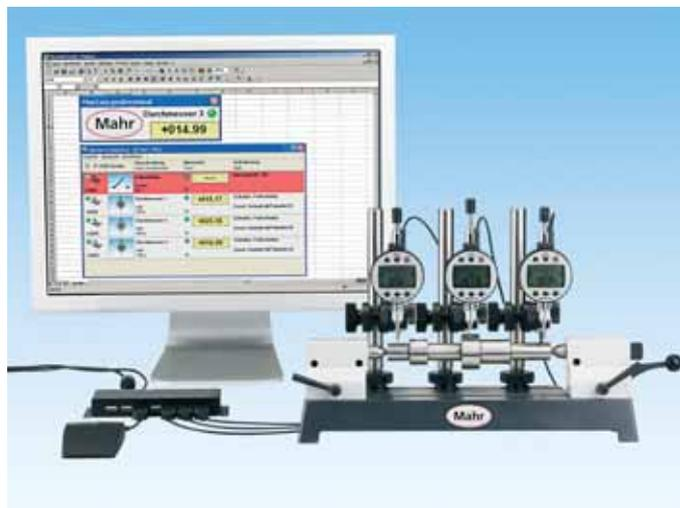
pomocí USB kabelů. Díky této flexibilitě je možné vytvářet komplexní měřicí stanice. K přenosu hodnot je pak využíván software MarCom, jehož standardní verze je zdarma u každého USB přijímače nebo USB datového kabelu. Standardní verze softwaru MarComu umožňuje přenos z 1 měřidla, profesionální, zpoplatněná verze, pak přenos z více měřidel do jednoho počítače.
