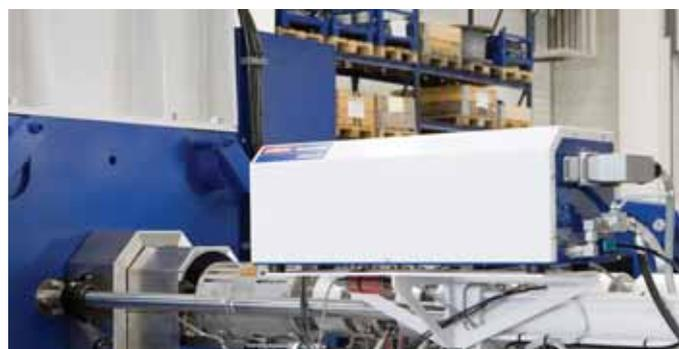
Modul pro regulaci plynu pro aplikaci CELMOULD na stroji EcoPower 240
