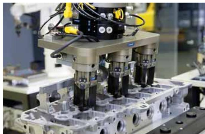
SCHUNK multi-uchopovače s citlivou kompenzačnou jednotkou zabezpečujú vysoké úrovne produktivity v montáži ventilov
