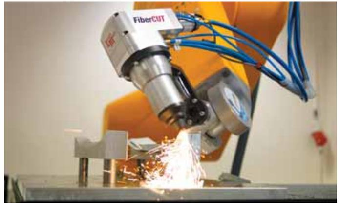
Robot Stäubli RX160 s laserovou hlavou při ořezu kovového dílu
