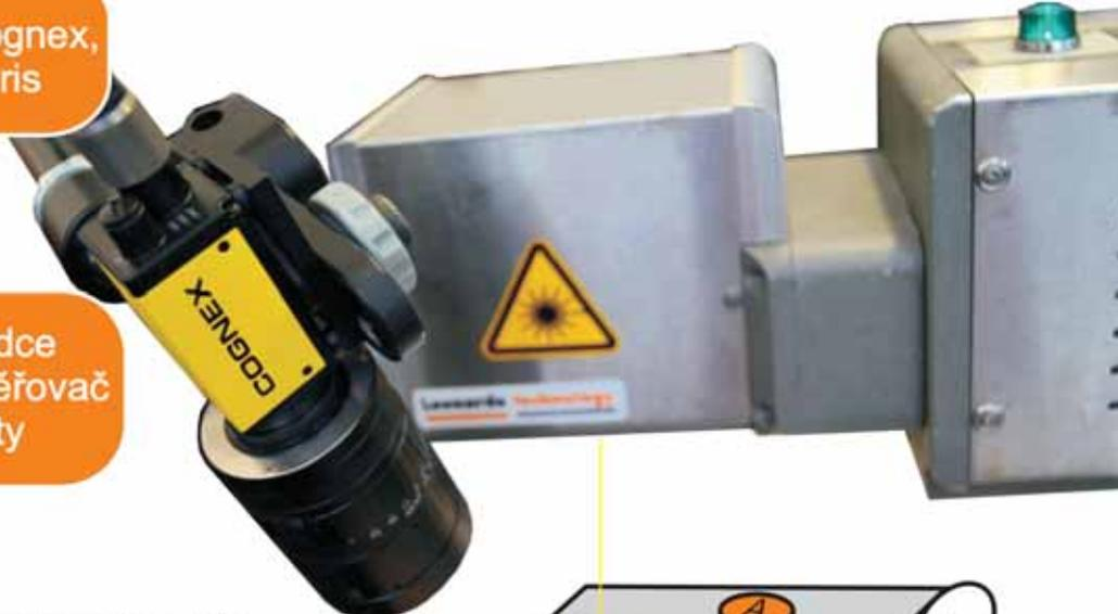
Když k laseru připojíme kameru, tak je velmi jednoduché sledovat polohu produktu a i jeho natočení. Údaje o poloze a natočení produktu se zasílají přes ethernetový kabel do laseru Solaris. Laser automaticky přepočítává zadané parametry a polohuje tisknutý text na správné místo. Přesně se trefíme do produktu i s jeho natočením. Chyba není možná, minout produkt nelze, protože vše je připojené jen jedním kabelem a napřímo mezi laserem Solaris a kamerou Cognex.
