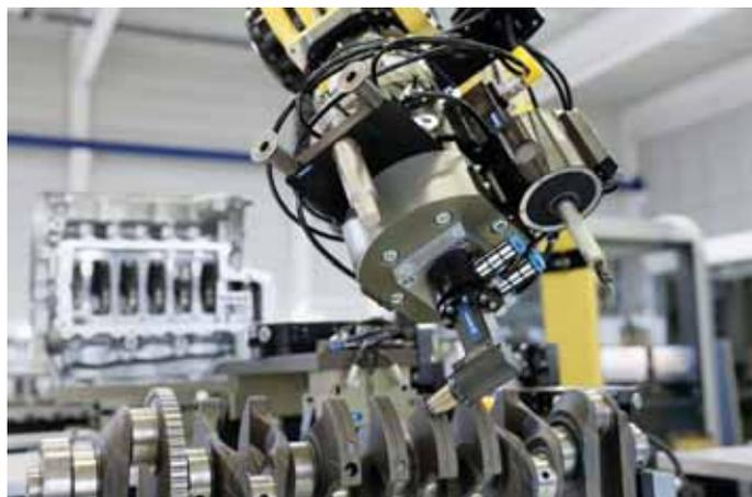
Flexibilné SCHUNK FDB odihlovacie vretiená umožňujú bezchybné výsledky v automatizovanom zrážaní
