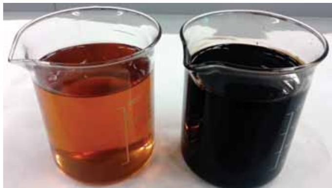
Obr. 2 Zmena farbenia a čírosti motorového oleja je spôsobená kontamináciou produktmi spaľovania ako aj degradáciou vlastných zložiek
