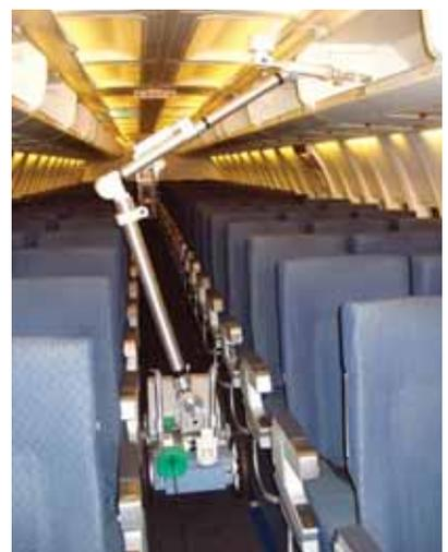
Na plošine robota je manipulačné rameno so siedmimi stupňami voľnosti, ktoré je určené na prehliadku kontrolovaného priestoru prostredníctvom farebnej prehľadovej kamery, manipuláciu s predmetom pomocou čelustí do maximálnej hmotnosti 2,5 kg a ako nosič RTG súpravy.
