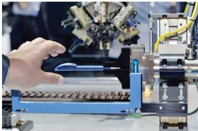
DGUV – certifikovaný SCHUNK bezpečný uchopovací systém poskytuje nový štandard pre bezpečnú spoluprácu človek/stroj
