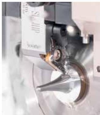
Obr. 2 – ISO sústružnícky držiak z radu SAFE-T-LOCK s možnosťou vysokotlakového chladenia.
