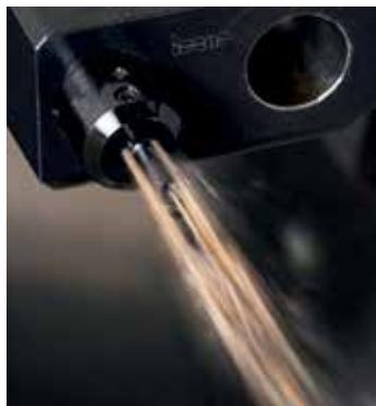
Obr. 1 – Celokarbidový mini nož PICCO s vnútorným chladením. Prívod chladiacej kvapaliny priamo na čepeľ zvyšuje efektivitu sústruženia.
