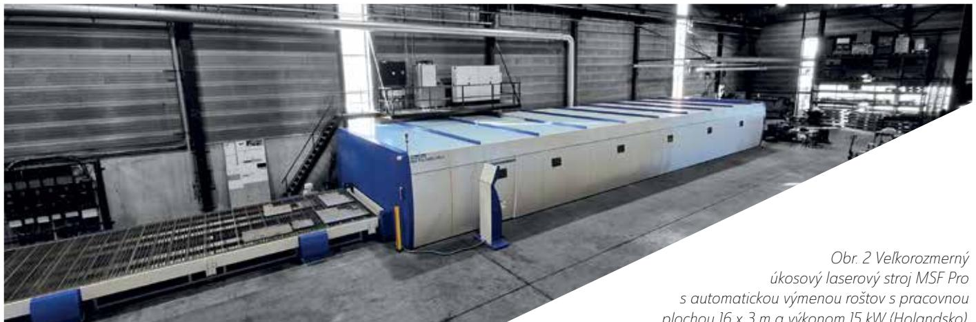
Obr. 2 Velkorozmerný úkosový laserový stroj MSF Pro s automatickou výmenou rošťov s pracovnou plochou 16 x 3 m a výkonom 15 kW (Holandsko).
