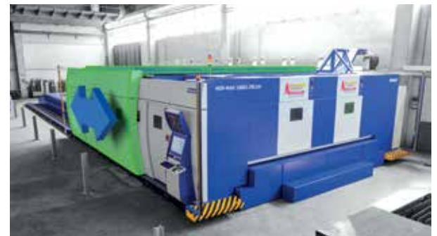
Obr. 5 MSF Max s teleskopicky vysúvateľnou presuvnou kabínou umožňuje meniť pracovnú plochu v rozmedzí 6 – 12 m
