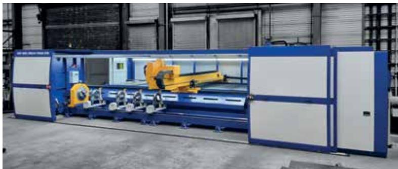
Obr. 3 Kombinovaný stroj MSF Pro s úkosovým rezaním plechov do rozmeru 6 x 2 m a rúr do dĺžky 6 m a Ø 300 mm (Nemecko)
