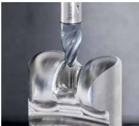
Obr. 4 – Použitie barelových fréz výrazne skracuje dobu cyklu pri obrábaní súčasti kolennej protézy – na obr. vymeniteľná karbidová barelová hlavička MM EOB z radu NEOBARREL.
