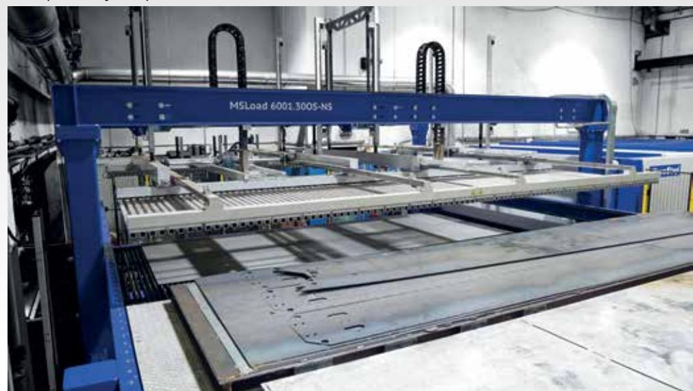
Obr. 7 Stredná, vykladacia plocha stroja so systémom MSLoad, so zásobou vyložených objednávok vpredu
