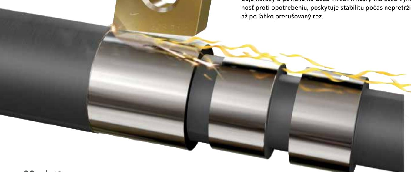
Pri hĺbkach rezu do 0,35 mm a pri rýchlosťach rezu okolo 300 m/min to znamená, že jediná trieda môže pokryť veľkú škálu aplikácií vo výrobe. To prináša zjednodušenie výberu náradia pre výrobu a CNC programovanie a významne znižuje náklady na zásoby.
