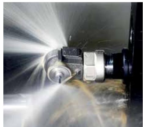
Obr. 5 – Vysokorýchlosné vreteno TJS M90 ST z radu SPINJET poháňané chladiacou kvapalinou, je účinným nástrojom pre zvýšenie rýchlosťi otáčok miniatúrnych rezných nástrojov.
