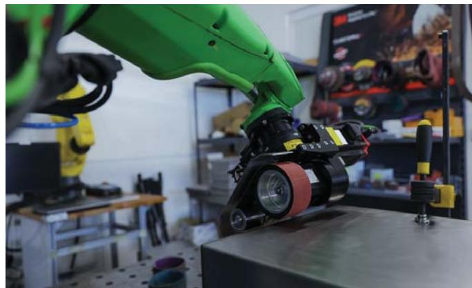
cia nástroja je našim vývojom. Jednotlivé komponenty sú zapojené integrovanou kabelážou. Na napínanie brúsneho pásu používame pneumatický piest, ktorý zároveň zabezpečuje centrovanie pásu.
