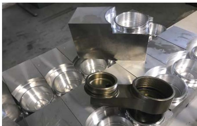
Počítav s hotový komponent vyrobený na obrábacom centre QT-COMPACT 200 MSY. FRT sa zameriava aj na nie celkom štandardné aplikácie a snaží sa využiť maximum technologických možností, ktoré Mazak ponúka.
