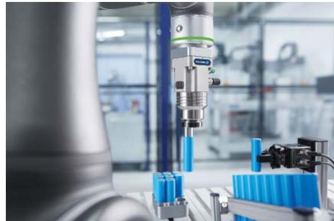
Rýchle a spoľahlivé uchopenie akumulátorových článkov, okrem iného: čas magnetizácie SCHUNK EMH, tu znázornený na jednopólovom variante, je len 200 ms.
