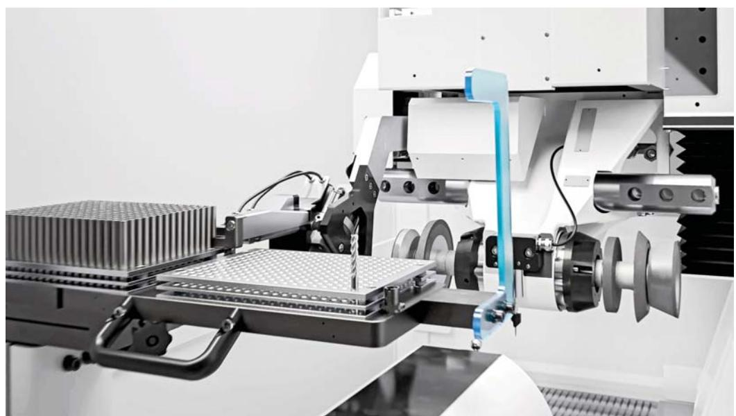
Varianta „Horní zakladač“ nabízí automatizaci bez zvětšení půdorysné plochy stroje.
