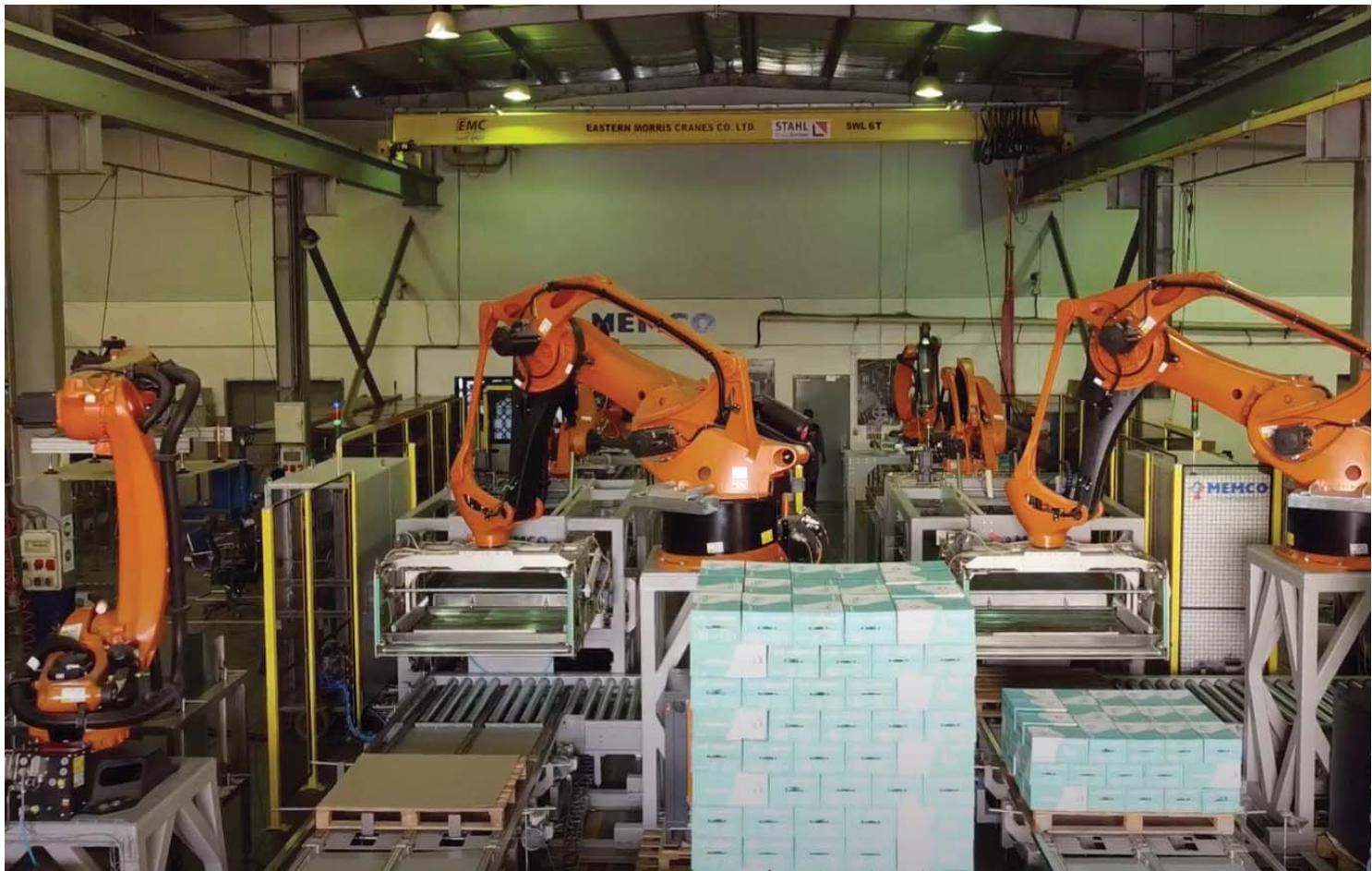
Tři různé paletizátory KUKA v provozu: automaticky stohují lahve s vodou.
