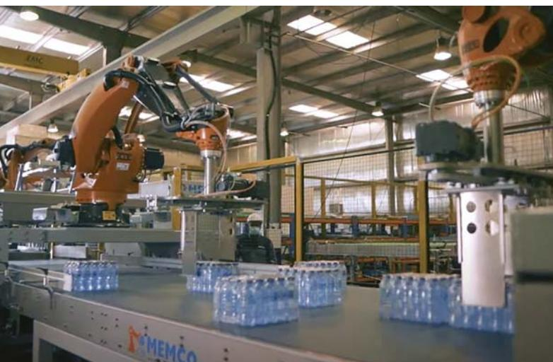
Dva PA KR 40 třídí lahve s vodou na dopravníku v ideálním rozestupu – jedno balení vlevo, jedno balení vpravo.
