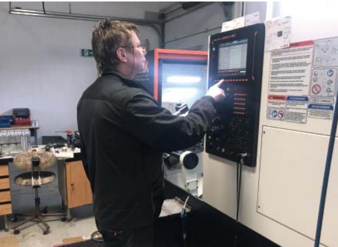
Výrobu na centre Mazak QT-COMPACT 200 MSY vo Ferenz Racing Technology má pod palcom Anton Stropkovič, takisto niekdajší automobilový pretekár. Jednoduchosť, intuitívnosť a komfort riadiaceho systému Mazatrol pre obsluhu stroja je jedným z dôvodov, prečo sa vo FRT rozhodli pre kúpu ďalšieho obrábacieho centra Mazak.
