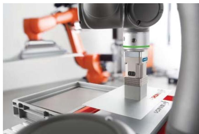
Komponenty sa jednoducho uchopujú zhora – uchopovaciú silu je možné nastaviť v štyroch stupňoch.
