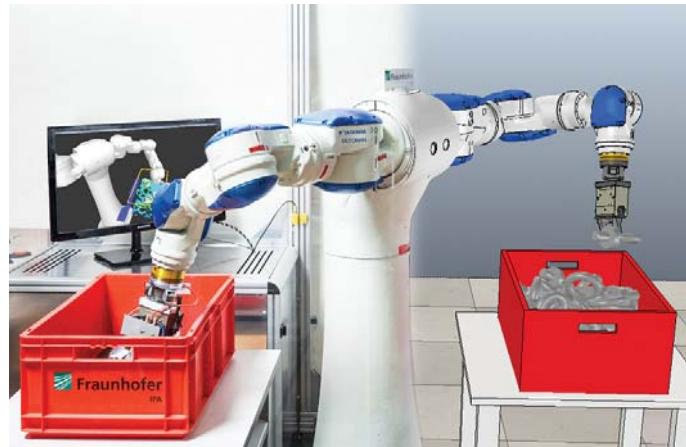
inteligencí. Většina dnešních robotů však standardně pracuje naslepo. Integrace kamery a snímače síly musí být v budoucnu součástí rozsahu výkonu standardního robota pro Smart Factory. Zásadní je také virtuální tréninkové prostředí. Průmyslový robot potřebuje digitální dvojce pro generování tréninkových dat v simulaci, aby byl skutečný robot ihned produktivní.“
