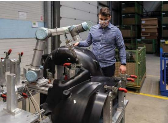
Efektivita procesu ultrazvukového sváření podběhů kol se po implementaci kolaborativního robota UR5 do výroby výrazně zlepšila.
