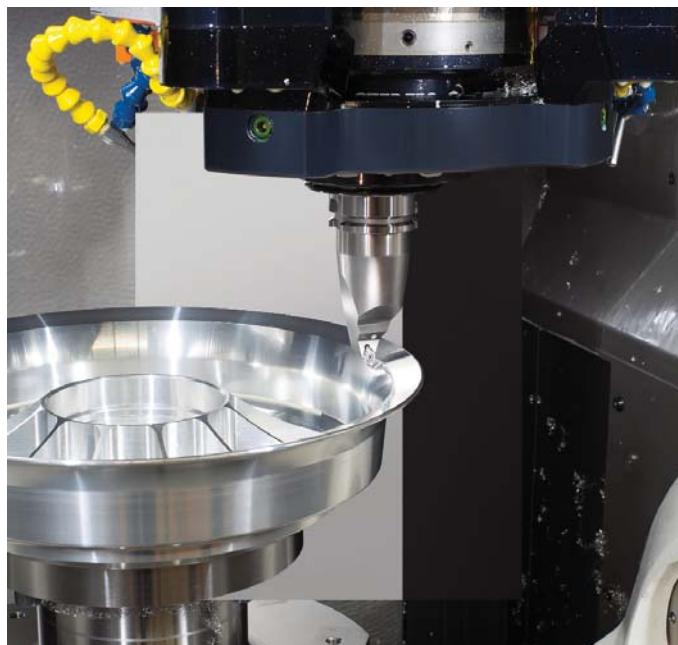
Obr. 4 Příklad soustružení na obráběcím stroji Mikron MILL P 800 U ST
