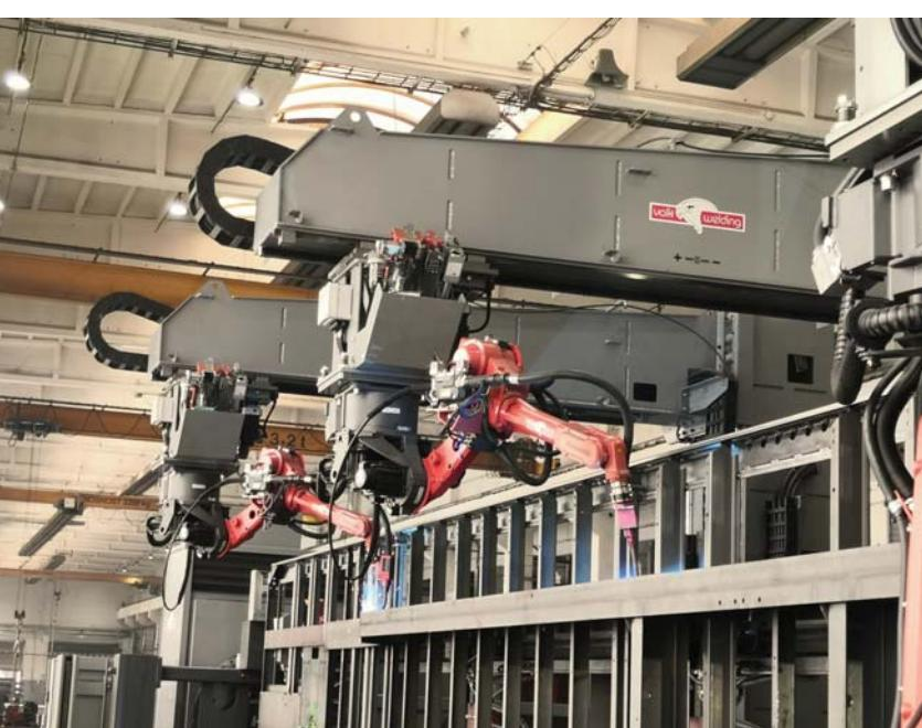
Podvozkové rámy pre návesy a prívesy nákladných automobilov nie sú práve najjednoduchšie komponenty strojárskej výroby. S dĺžkou zvarenca dosahujúcou až 14 metrov, hmotnosťou rátajúcou sa v tonach a extrémne vysokými požiadavkami na pevnosť a kvalitu celej zvárenej konštrukcie si ich produkcia vyžaduje skutočne pokročilé know-how a zodpovedajúcu progresívnu technológiu výroby, ktorá sa v dnešnej dobe už nezaobíde bez robotického zvárania.
