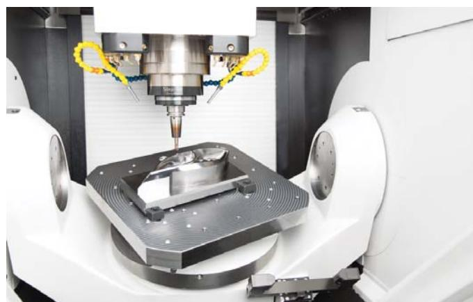
Obr. 2 Symetrický naklápěcí a otočný stůl je vybavený přímým pohonem
