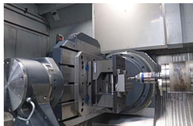
Nová přesná vyvrtávací hlava KOMflex od společnosti CERATIZIT využívá bezdrátovou rádiovou technologii BLUM (rádiové rozhraní RC66 vlevo nahoře) pro intelligentní vyvrtávání otvorů se samokorekcí (kompenzace ostří). To je ideální pro automatizované obrábění ložiskových sedel a vysoce přesných otvorů válců, apod.
