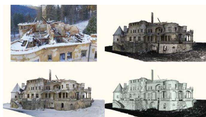
Vygenerovaný 3D model na základe kombinácie laserového skenovanie a fotogrammetrie s aplikovanou textúrou
