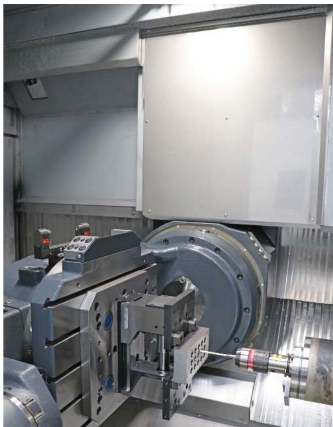
Měřicí sonda BLUM si také vyměňuje data s řídícím systémem stroje prostřednictvím bezdrátového rozhraní RC66 (vlevo nahoře).
