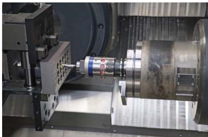
Nová přesná vyvrtávací hlava KOMflex od společnosti CERATIZIT je kompaktní a výkonná. Pracuje při rychlostech až 8000 ot./min a zajišťuje polohovou přesnost v krocích po 0,001 mm. Rozsah nastavení je +/- 0,25 mm.
