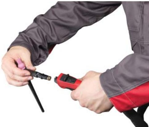
Stačí pootočiť a nasadiť – systém Multilock umožňuje rýchlu a jednoduchú výmenu tela zváracieho horáka.
