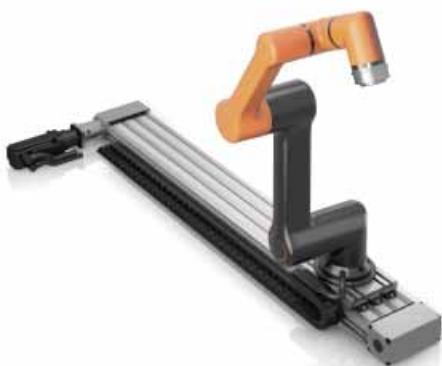
Kompaktná lineárna os firmy Schaeffler pripravená na montáž sa skladá z tandemového modulu MDKUVE, príslušnej jednotky motora/prevodovky, prefabrikovaných káblov motoru, ľažnej reťaze pre všetky zásobovacie vedenia cobota a riadiacej jednotky motora. Dlhšie lineárne osi sú vytvorené ako viacdielne lineárne moduly, vďaka čomu je možné realizovať dráhu pojazdu cobota v dĺžke až 18 metrov.
