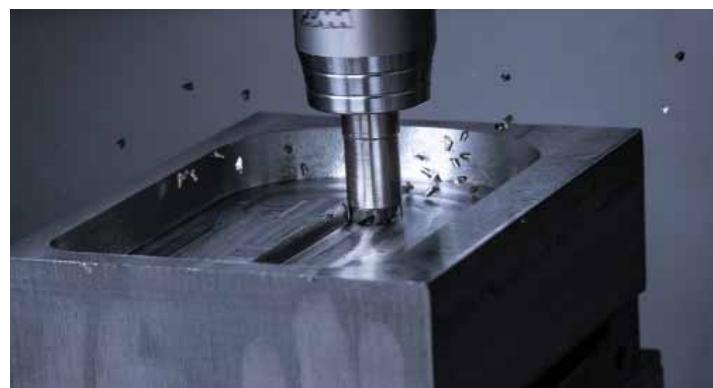
Modulárni frézovací systém MultiLock WNT z dílny CERATIZIT
