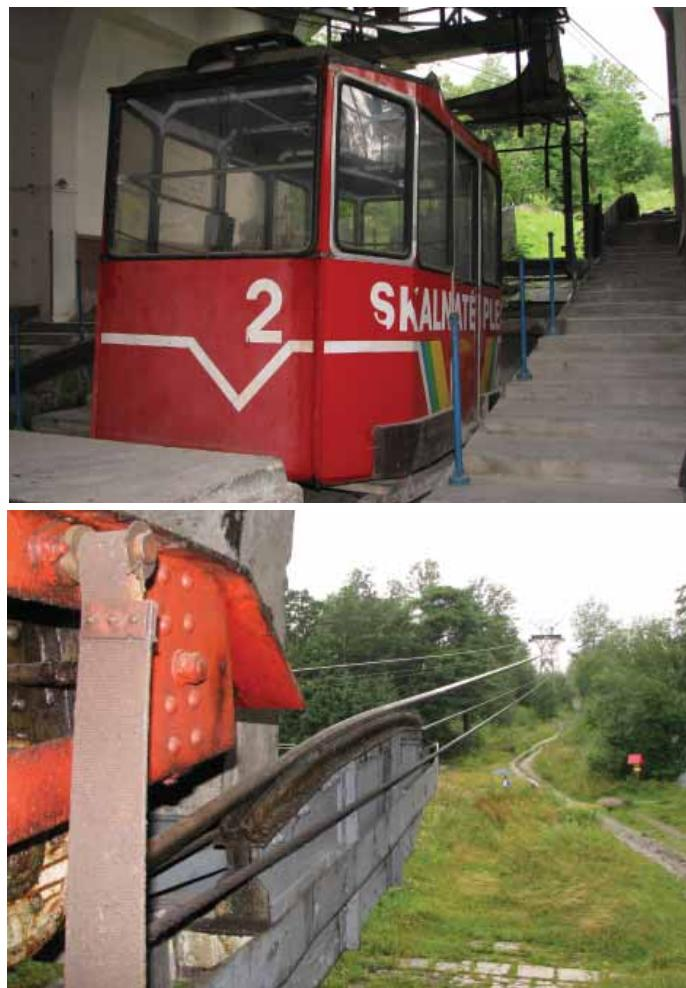
Obr. 3 Vyslúžilá kabína lanovky v Tatranskej Lomnici, uloženie nosného a 2 ťažných lán (foto M. Fabian)
