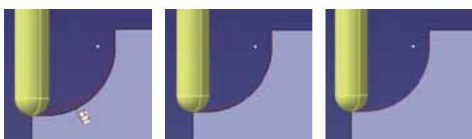
Obr. 3 MT – maximálne prípustná odchýlka dráhy nástroja od teoretického povrchu (zľava doprava MT=1 mm, MT=0,5 mm, MT=0,01 mm)
