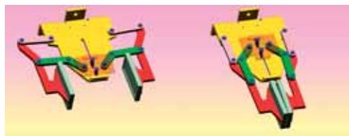
Obr. 4 Návrh chápadla manipulátora
