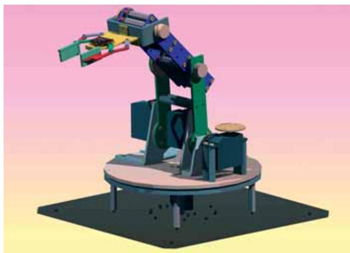
Obr. 2 3D model manipulátora StanleyBot1
