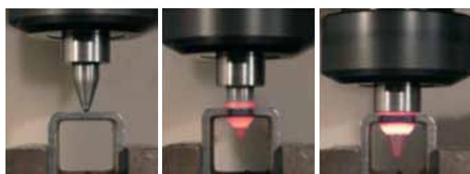
Obr. 4 Postupnosť termálneho vŕtania Flowdrill
