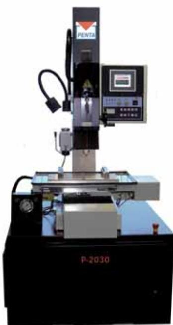
využiť pre dierovanie veľmi presných otvorov. Na príname zákazníka môže byť vybavená automatickým výmenníkom trubičiek alebo vedenia. Ponúkaná je takisto možnosť pripojenia ďalšej rotačnej osi pre vŕtanie po obvode obrobku a dodatočné vybavenie stroja do plnej automatizácie, a to vrátane výmeny kusu pomocou robotickej ruky. Samozrejmosťou je moderný dizajn a kvalitný generátor.
