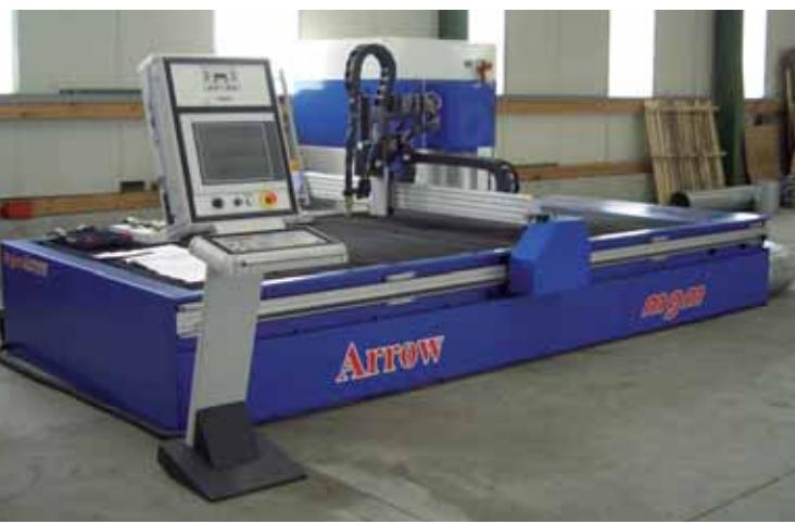
Systém MS 200 mimo iného, ponúka kompletný transmit dvoch plazmových zdrojov rôzneho typu, „pudové“ nastavenie rezných parametrov, ktoré eliminuje riziko nesprávneho nastavenia stroja, a tým znižuje možnosť nepodarkov. Spoločnosť MGM do svojho riadia-
