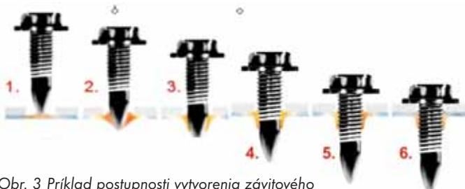
Obr. 3 Priklad postupnosti vytvorenia závitového spoja s vŕtacou skrutkou firmy Bossard pomocou FDS® systému
