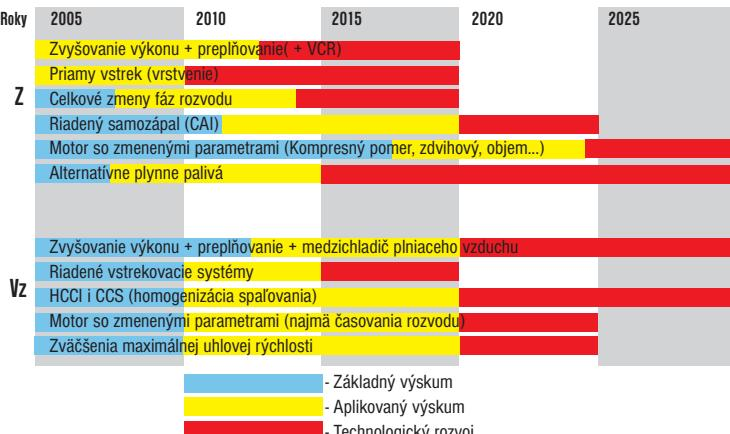
Obr. 11. Sumarizácia trendov rozvoja spaľovacích motorov
