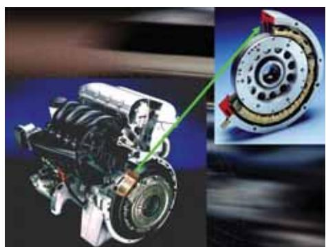
Obr. 13 Usporiadanie systému CSA (štartér - alternátor v zotrvačníku)
