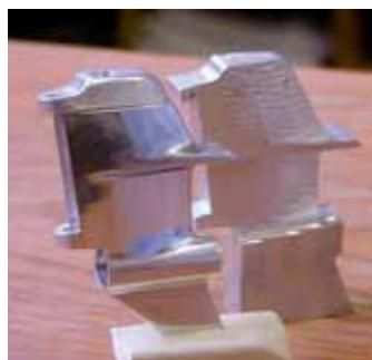
Obr. 6 Model plutvy, hrubovaný polotovar a finálny povrch
