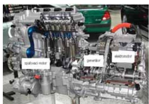
Obr. 15 Hybridný pohon (spaľovací motor - elektromotor - generátor) a predpoklad vývoja k hybridným pohonom
