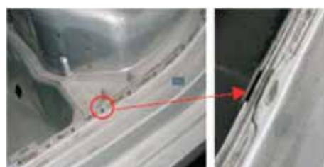
Obr. 2 Využitie bodového odporového zvárania v automobilovom priemysle – karoséria automobilu Volkswagen Polo
