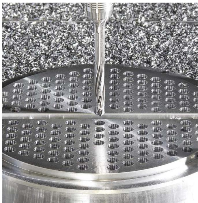
Skrútkovica s premenným uhlom v telesse vrtáka zlepšuje dynamické správanie a zvyšuje maximálnu možnú hĺbku vŕtania s 3-brítovým vrtákom až na 8D.
