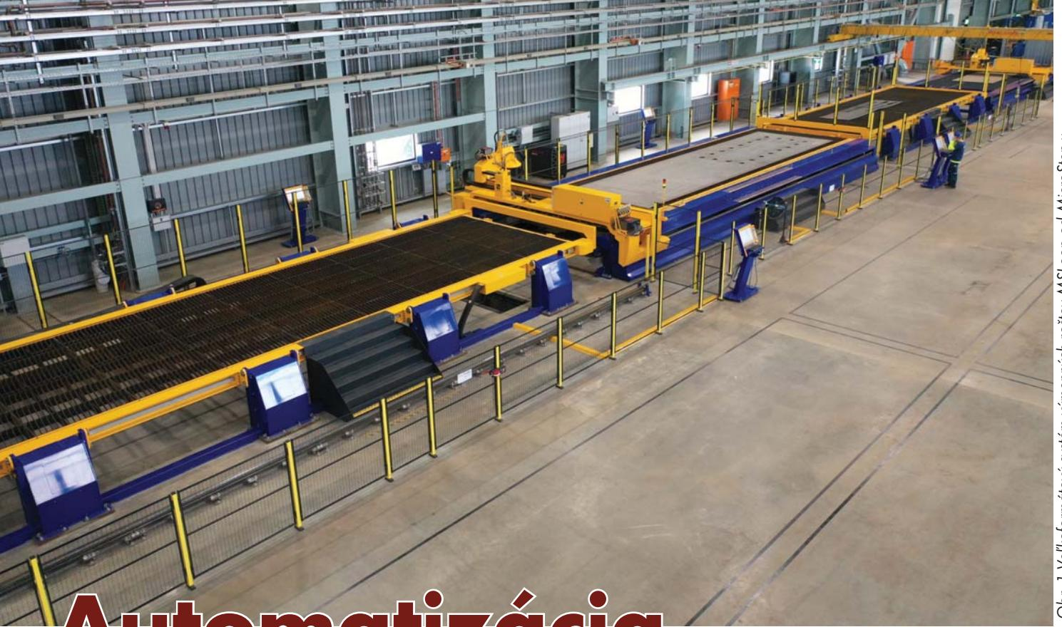
Obr. 1 Veľkoformátový systém výmenných rošťov MSLoop od MicroStep s troma pracovnými pozíciami (miesto inštalačie: Adelaide, Austrália)
