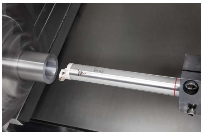
Antivibračné vyvŕtavacie tyče WHISPERLINE umožňujú stabilný rez s vyložením až 14-násobku priemeru.
