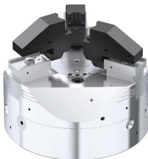
RAPIDO rýchlo-výmena. Pomocou systému rýchlej výmeny SCHUNK RAPIDO možno 3-čelusťové sklučovadlá nanovo osadiť v priebehu 60 sekúnd. Zaistenie zaručuje maximálnu bezpečnosť aj v prípade, že sa sklučovadlo používa na horizontálnom alebo vertikálnom vretene. Systém možno prevádzkovať manuálnym alebo plne automatizovaným spôsobom.
