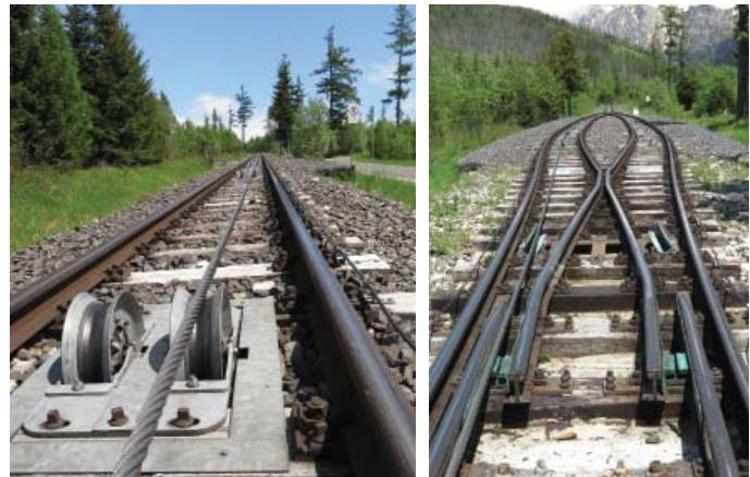
Obr. 12 Vodiacie kladky lana priameho úseku trate (vľavo) a vodiacie kladky na Abtovej výhybni (vpravo) (foto M. Fabian)
