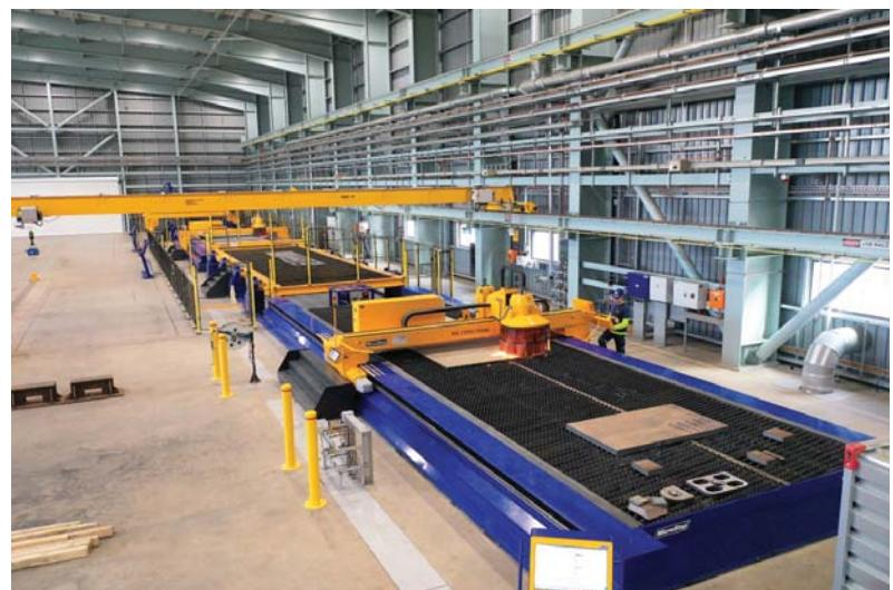
Obr. 5 Súčasťou projektu v austrálskej lodenici je aj samostatný stroj na rezanie kyslíkom, ktorý slúži na úkosové rezanie hrubých materiálov s prípravou zvarových plôch.
