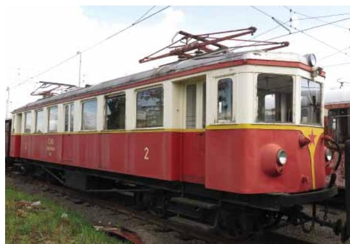
Obr. 2 Elektrický motorový vozeň Ringhoffer (EMU 49.001)
