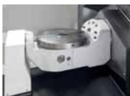
Naklápací, otočný stůl s indexací 0,0001° pro plynulé obrábění, maximální průměr obrobku je 500 mm a výška 320 mm
