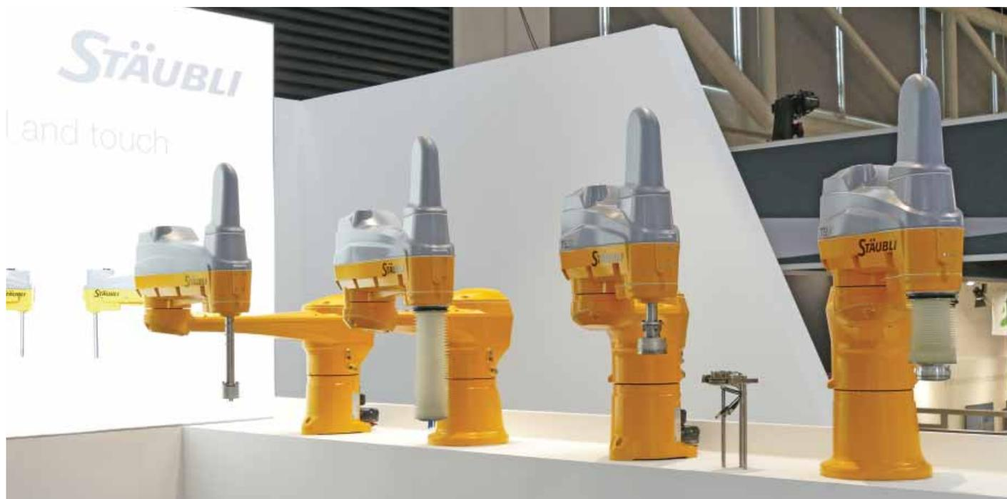
Nové SCARA roboty mají modulární design a, poprvé, vlastní Staubli JCS převodovku, která je již novým standardem u šestiosých systémů a je klíčová pro obrovský výkon podávaný čtyřosými TS2. Technologie duté hřídele umožňuje unikátní čistý design, který odsouvá vnější vedení kabelů do minulosti.
