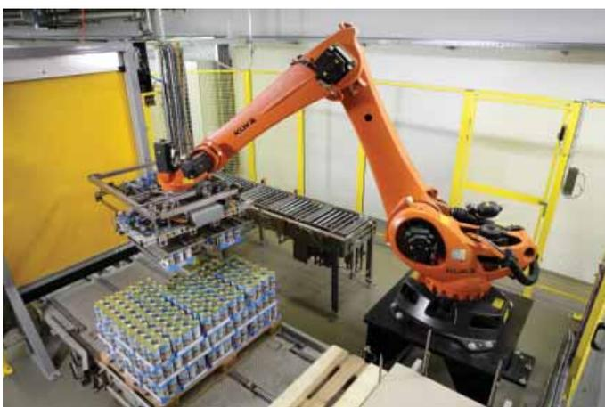
*Automatizované paletizování plechovek bavorských klobás není žádným problémem díky paletizačnímu robotu KUKA*
