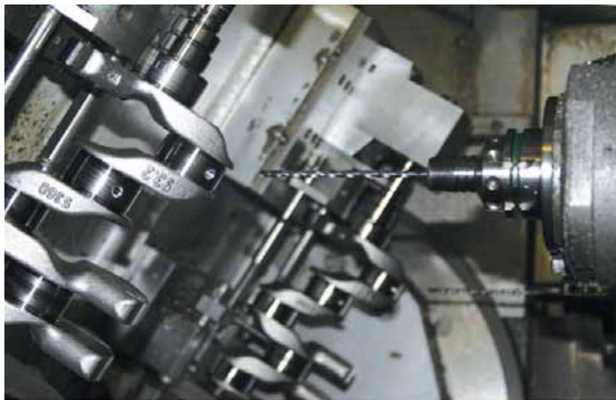
**MPS1 - vrtanie hlbokého mazacieho otvoru od uloženia ojníčného ložiska k hlavnému ložisku kľukového hriadeľa na stroji Grob BZ530**
