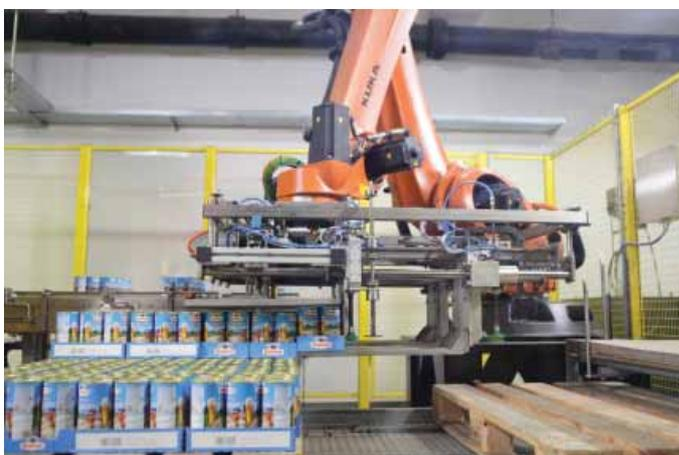
*Paletizační KUKA robot zpracovává 48 různých kombinací balíčkových vzorů*
