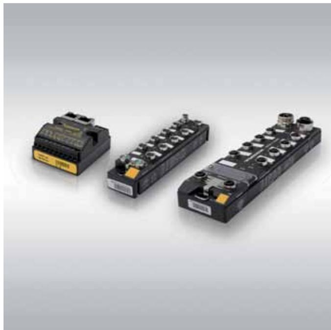
multiprotokolové vstupno-výstupné zariadenia detegujú master hneď po štarte a zvolia automaticky detegovaný protokol. Prístup na čítanie prostredníctvom ModbusTCP je dokonca možný, aj keď kontrolér komunikuje po Profinete alebo Ethernet/IP. Týmto spôsobom môžu HMI ako aj okrajové brány a cloudové systémy paralelne pristupovať k všetkým procesným hodnotám s PLC.
