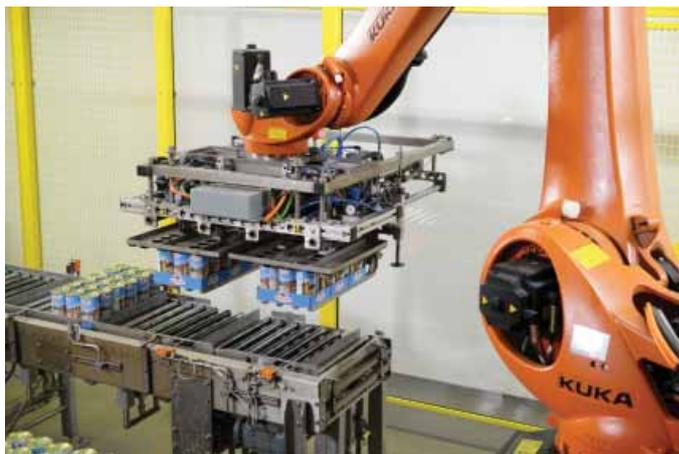
*Robot KR QUANTEC, vybavený multifunkčním chapadlem, provádí paletizaci*
