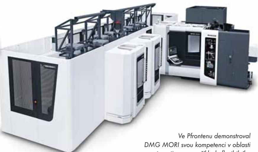
Ve Pfrontenu demonstroval DMG MORI svou kompetenci v oblasti automatizace na příkladu flexibilního automatizovaného výrobního systému s horizontálními obráběcími centry NHX 5000 a DMC 60 H linear ve spojení s lineárním zásobníkem palet LPP 24
