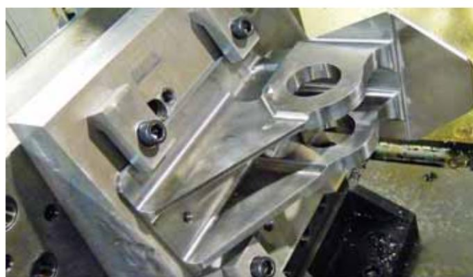
Výstuž vyrobená z TA6V (Ti-6Al-4V)
