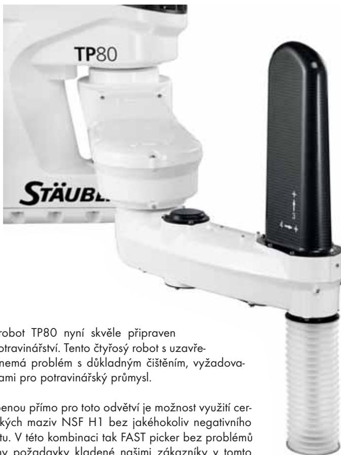
Díky HE verzi je tak robot TP80 nyní skvěle připraven na veškeré aplikace v potravinářství. Tento čtyřosý robot s uzavřenou strukturou ramene nemá problém s důkladným čištěním, vyžadovaným hygienickými normami pro potravinářský průmysl.
