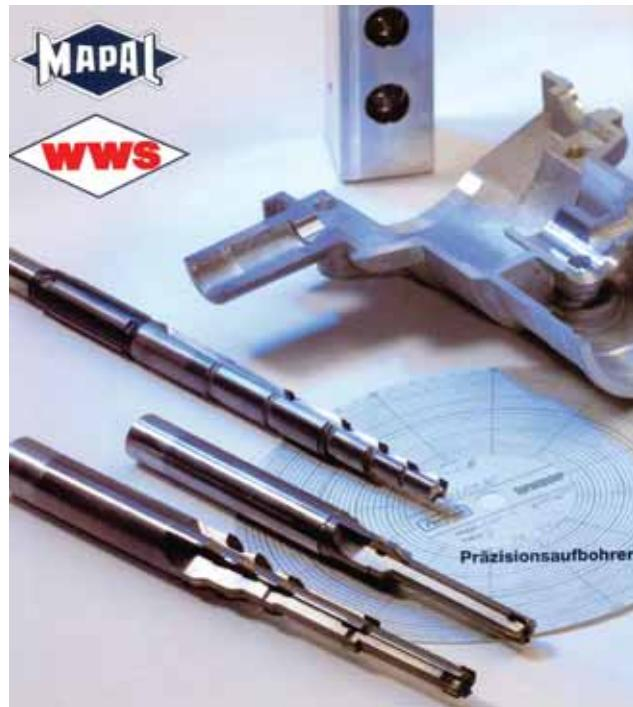
Obr. 5 Rôzne prevŕtavacie, zahľbovacie a vystružovacie nástroje pre AlSi zliatiny s prispájkovanými platničkami PKD a s vnútorným chladením od fyrmapal-WWS GmbH (DE). /2/
