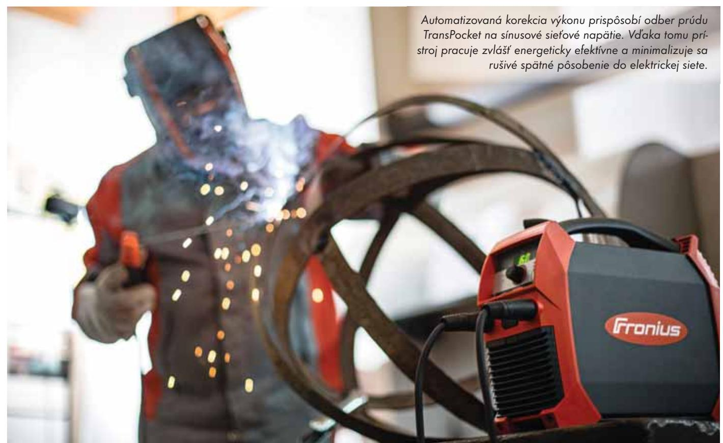
Automatizovaná korekcia výkonu prispôsobí odber prúdu TransPocket na sínusové sieťové napätie. Vďaka tomu prístroj pracuje zvlášť energeticky efektívne a minimalizuje sa rušivé spätné pôsobenie do elektrickej siete.
