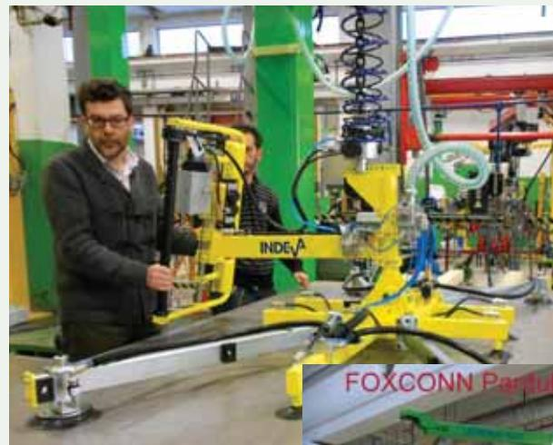
Balancéry jsou elektronicky a pneumaticky řízené systémy stálého vyvažování hmotnosti břemene do stavu „bezvíže“. Umožňují jednoduchou manipulaci s břemenem až do hmotnosti 320 kg, při které je námaha redukována na minimum a břemo kopíruje pohyb lidského ramene.
