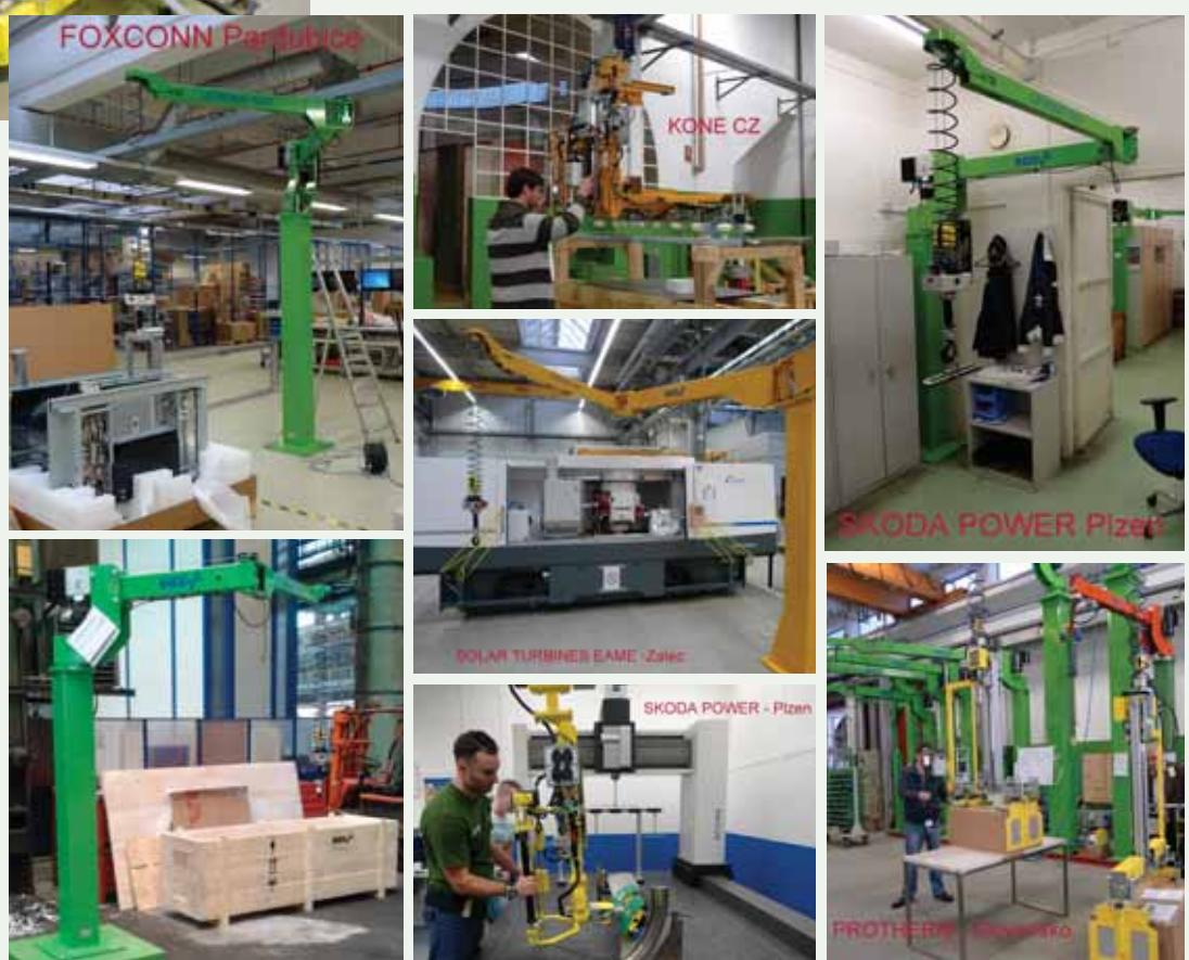
Operátor může zdvihnout břemeno s hmotností až 320 kg jednoduchým doteckem se servo-ovládací rukovětí nebo záťže samotné a přemístit ji lehkým tlakem požadovaným směrem, jakoby břemene vážilo jen několik gramů.
