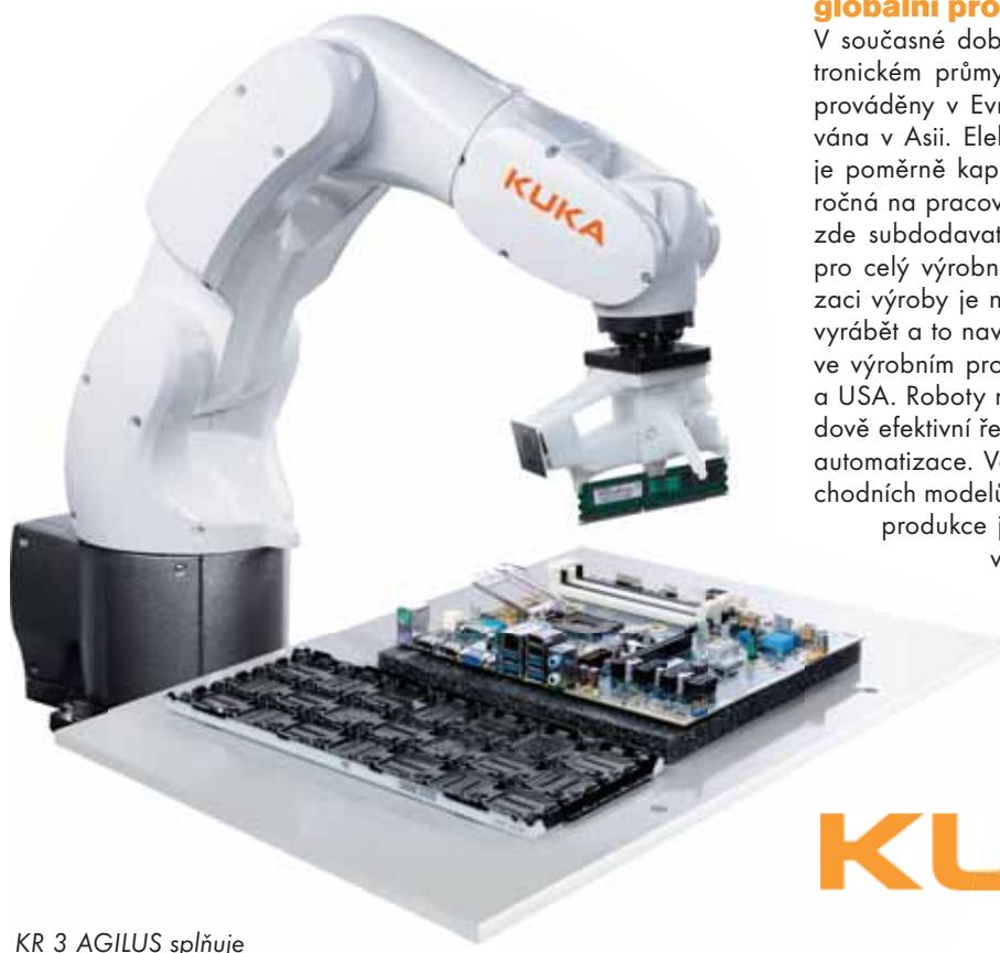
KR 3 AGILUS splňuje zvláštní požadavky výroby v odvětví 3C (počítače, komunikační techniky a spotřební elektroniky).
