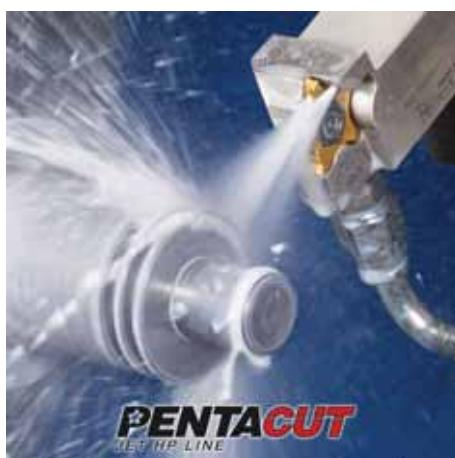
ISCAR vyvinul aj pre štandardné **ISOTURN** sústruženie jedinečný vysokotlakový chladiaci systém. Tento pozostáva z fixného elementu a teleskopické výsuvnej hubice pre lepšie smerovanie chladiva presne k reznej hrane vymeniteľnej reznej doštičky. Teleskopická trubica vložená do puzdra môže byť nasmerovaná vpravo či vľavo v závislosti od smeru pracovného posuvu nástroja. Pri výmene reznej doštičky nie je potrebné odpojenie chladiaceho systému z držiaka doštičky.
