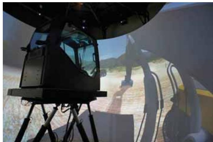
Obr. 1 „human-in-the-loop“ simulátor pro testování nových stavebních strojů
