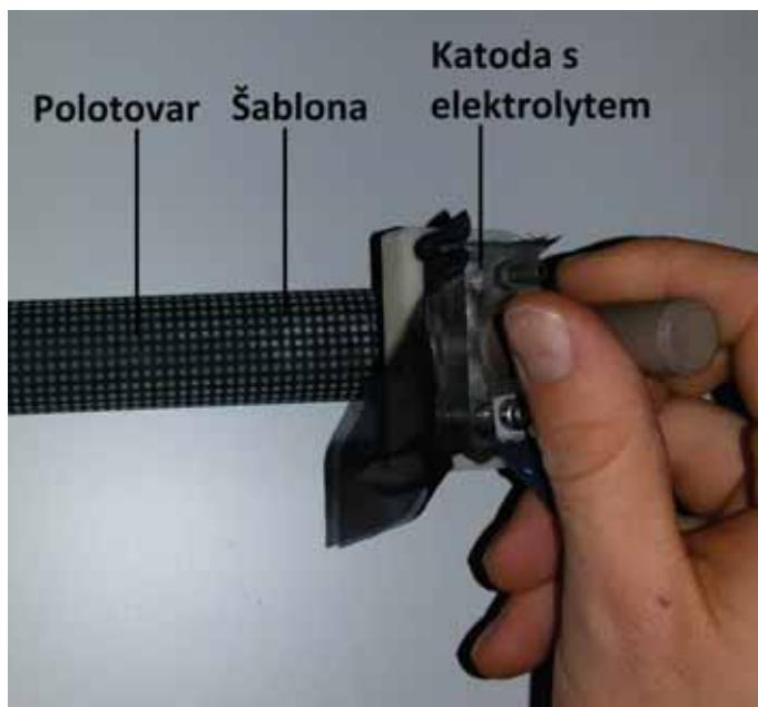
Obr. 1 Nanášení deformační sítě
