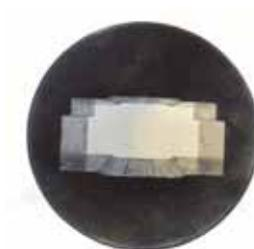
Obr. 4 Tvar pretiahnutého otvoru s preťahovacími trňmi č. 1 až 12, s dosiahnutou drsnosťou povrchu  $Ra \leq 3,2 \mu\text{m}$ , namerané hodnoty  $Ra = 1,6 \div 2,2 \mu\text{m}$ .
