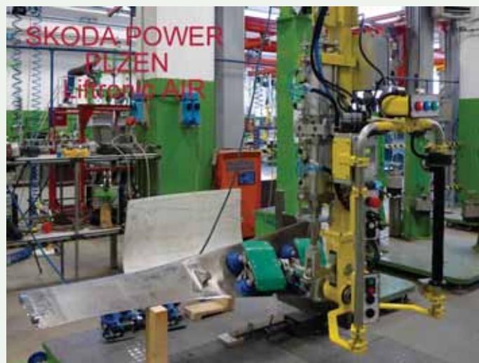
Balancéry jsou elektronicky a pneumaticky řízené systémy stálého vyvažování hmotnosti břemene do stavu „beztíže“. Umožňují jednoduchou manipulaci s břemenem až do hmotnosti 320 kg, při které je námaha redukována na minimum a břemeno kopíruje pohyb lidského ramene.
