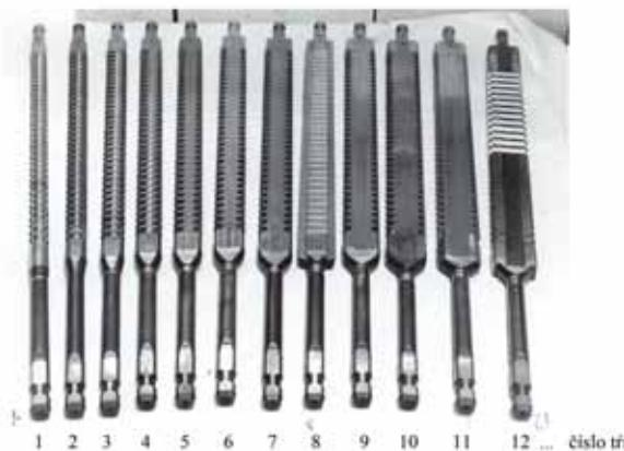
Obr. 3 Sada 12 preťahovacích trňov s progresívou skupinovou schématizáciou rezania
