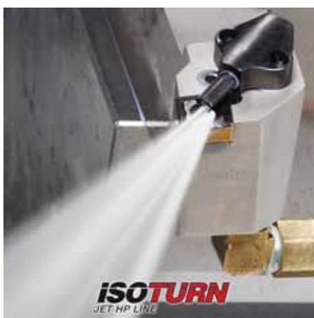
ISCAR JETHP systém je inovatívne riešenie pre jedinečné nástrojové ISCAR systémy. Investícia do (HPC) – vysokotlakového chladiaceho systému, povýšuje bežné obrábanie na oveľa vyššiu úroveň.
