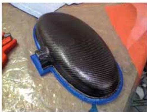
Laminace horní plovniny sání na formu
