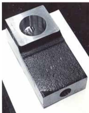
Pred preťahovaním tvarového otvoru sa zhotoví východzí otvor  $\varnothing 40$  H9 x 290 mm, pre vedenie preťahovacieho trna kruhového prierezu. Pripravená súčiastka po ejektorovom vrtení, pred preťahovaním je na obr. 1.
