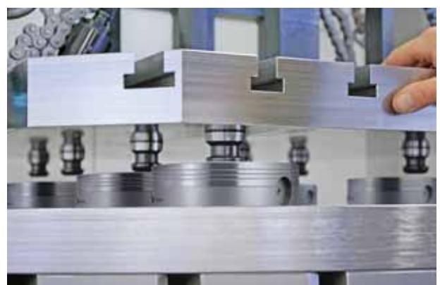
**Časovo efektívny:** VERO-S rýchlovýmenný paletový systém minimalizuje prípravný čas a zaručuje maximálnu presnosť.
