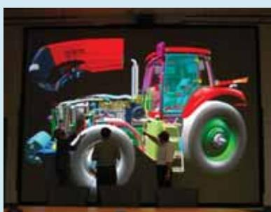
Obr. 4 Digitální model traktoru CASE zobrazený ve 3D pomocí stereoskopické projekce [5]
