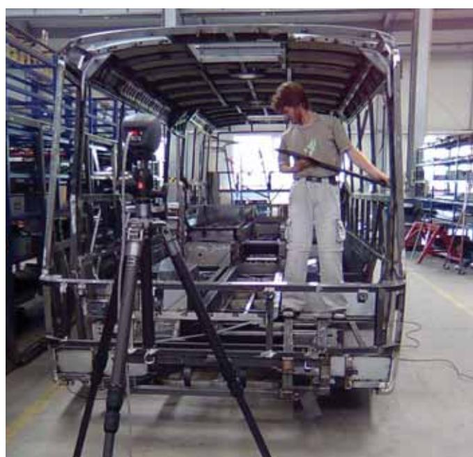
Obr. 3 Měření svařence
