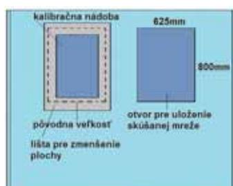
Obr. 2 Zmenšenie plochy kalibračnej nádoby
