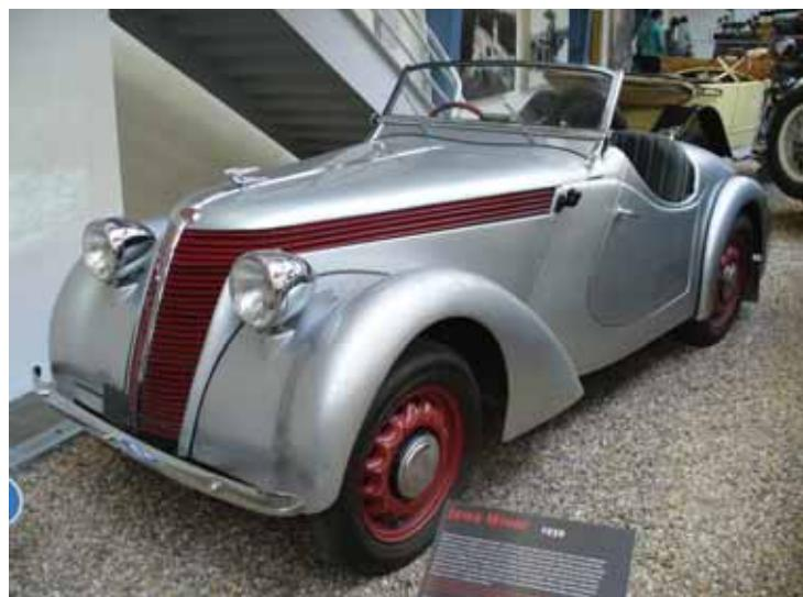
**Osobný automobil s kvapalinou chladeným štvortaktným štvorvalcovým motorom SV umiestneným pozdĺž za prednou nápravou a s pohonom zadných kolies. Zdvihový objem 1 661 cm<sup>3</sup>, výkon 25,7 kW (35 koní), maximálna rýchlosť 100 km/h. Výrobca: Československá - Kolben - Daněk, a.s., automobilné oddelenie Praga, Praha, Československo.**
