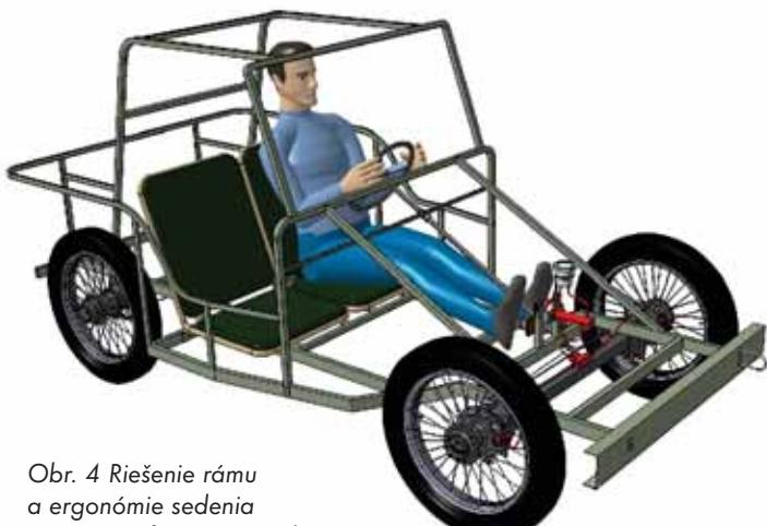
Obr. 4 Riešenie rámu a ergonómie sedenia za pomocí figuríny Manikin
