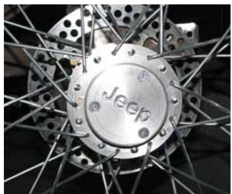
Obr. 7 Návrh krytov nábojov kolies a ich realizácia
