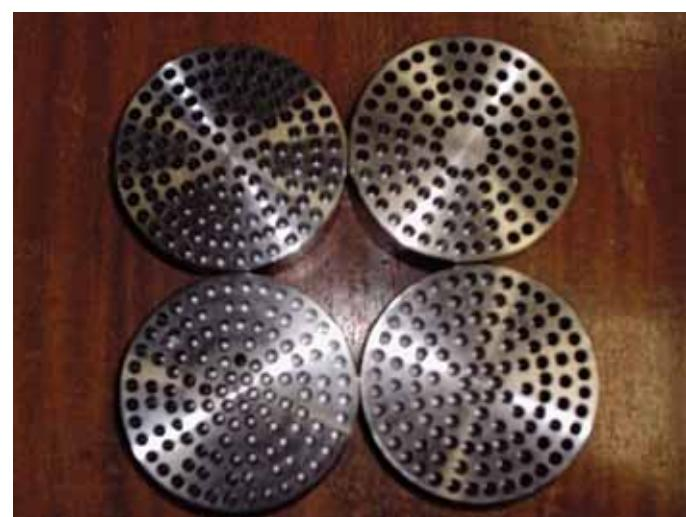
Obr. 2 Vzorky s obojstranne vyvŕtanými otvormi  $\varnothing 6 \times 20 \text{ mm}$  do materiálu 14 140.3
