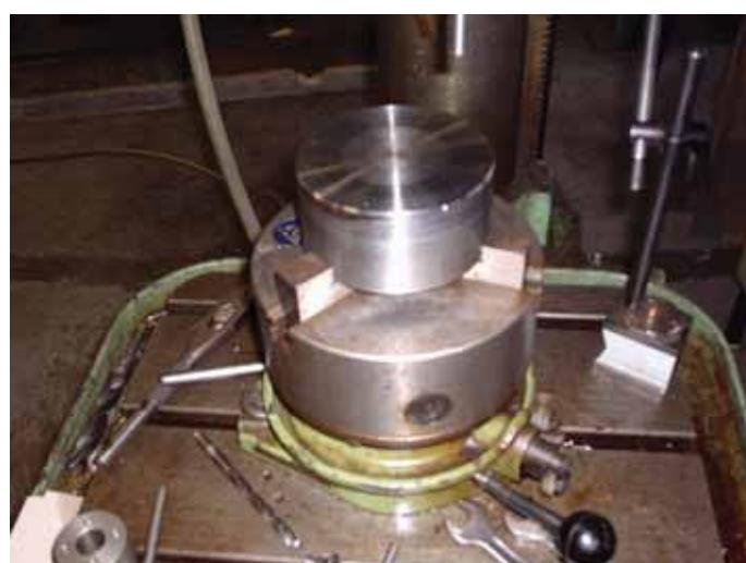
Obr. 1 Pohľad na pracovisko vŕtania dier  $\varnothing 6 \times 20 \text{ mm}$
