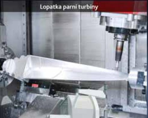
Obrábění lopatkového kola
