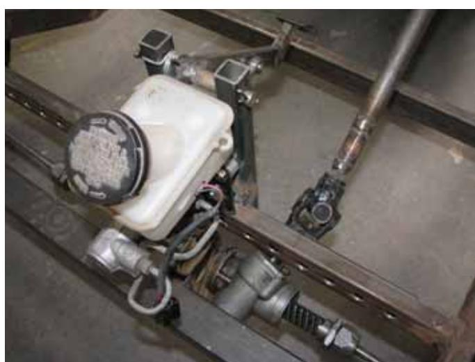
Obr. 5 Detailný pohľad riešenia umiestnenia hlavného brzdového valca a riadenia
